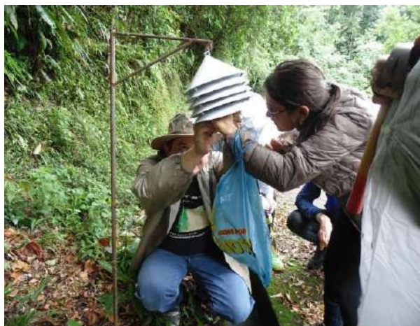
Figura 6: Instalação do abrigo meteorológico de ventilação passiva de baixo custo: 0,5 mm x 220 mm x 240 mm. Fonte: os autores.
