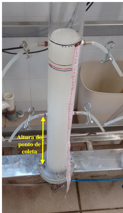
Figura 16 - Altura do ponto de coleta da coluna de ensaio de floculação e flotação
