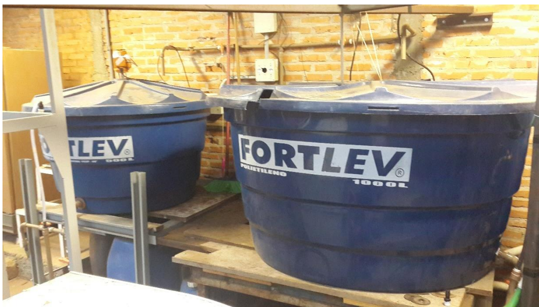
Figura 11 - Tanques de Alimentação do Reator Anaeróbico
