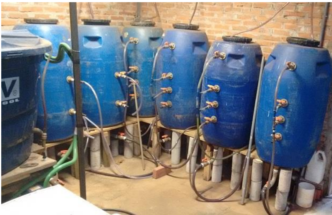
Figura 12 - Tanques de coleta do efluente para pós-tratamento
