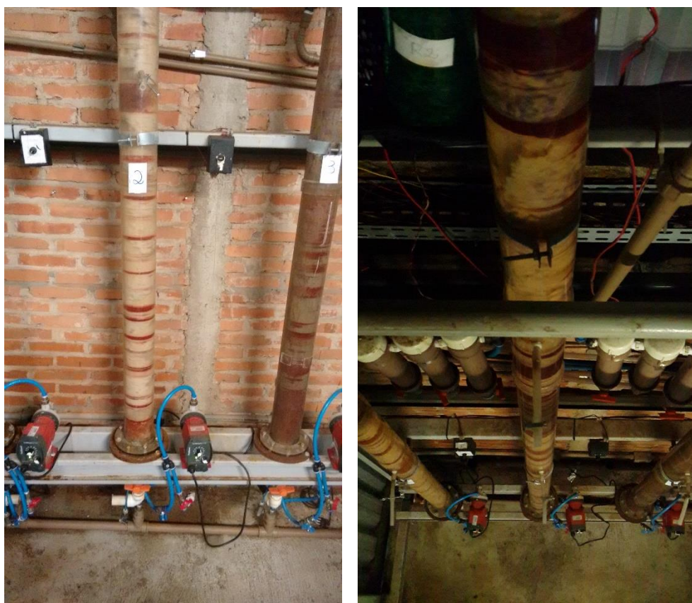
Figura 13 - Reatores anaeróbios utilizados na pesquisa de PELEGRINO (2016), com destaque para o reator 2 à esquerda
