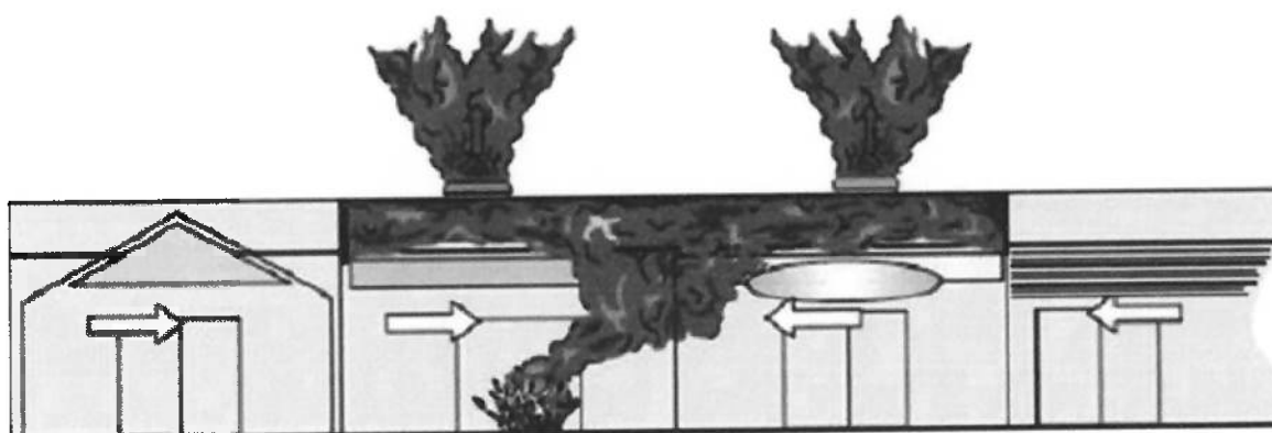
Figura 2.3 – Incêndio em um shopping center com um sistema de controle de fumaça
