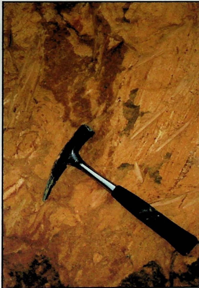
Foto 1 – Detalhe do solo de alteração do xisto migmatítico porfiroblástico milonitizado com xistosidade vertical a subvertical.
