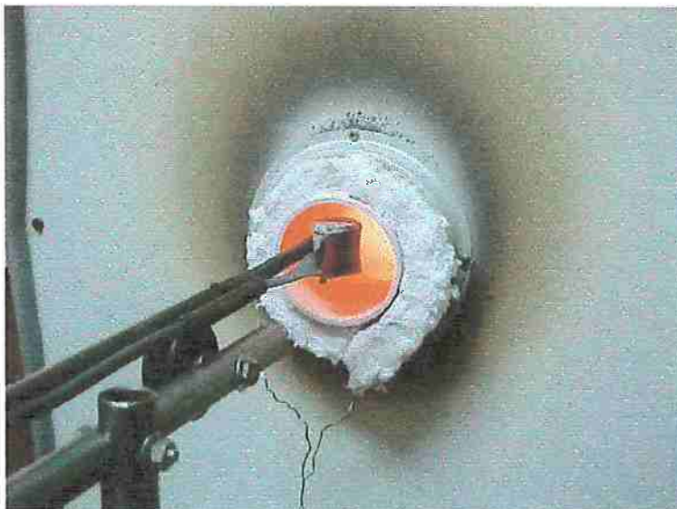
Figura 32: Entrada do cadinho de alumina no FTR na temperatura do ensaio isotérmico.
