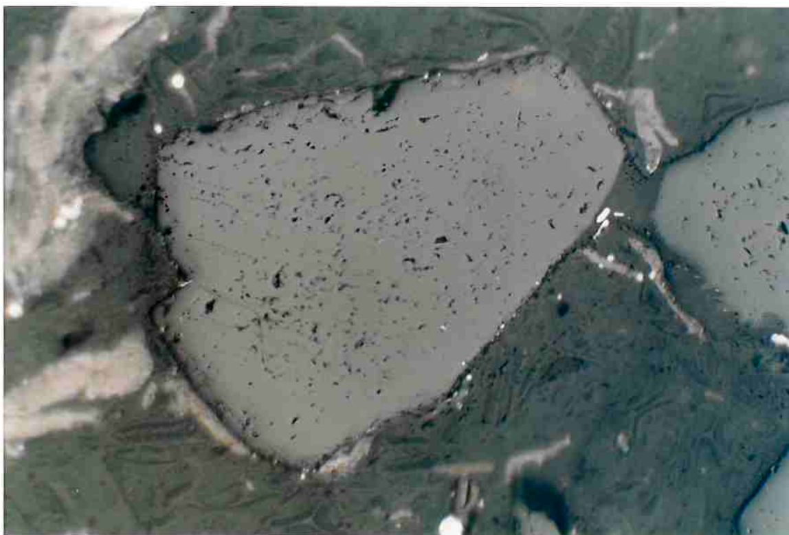
Figura 71: Micrografia óptica da cromita parcialmente reduzida a 9.56%, tempo=20min e aumento 429x.
