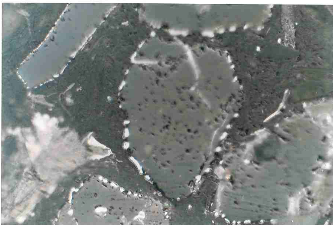
Figura 70: Micrografia óptica da cromita parcialmente reduzida a 27.38%, tempo=200min e aumento 429x.
