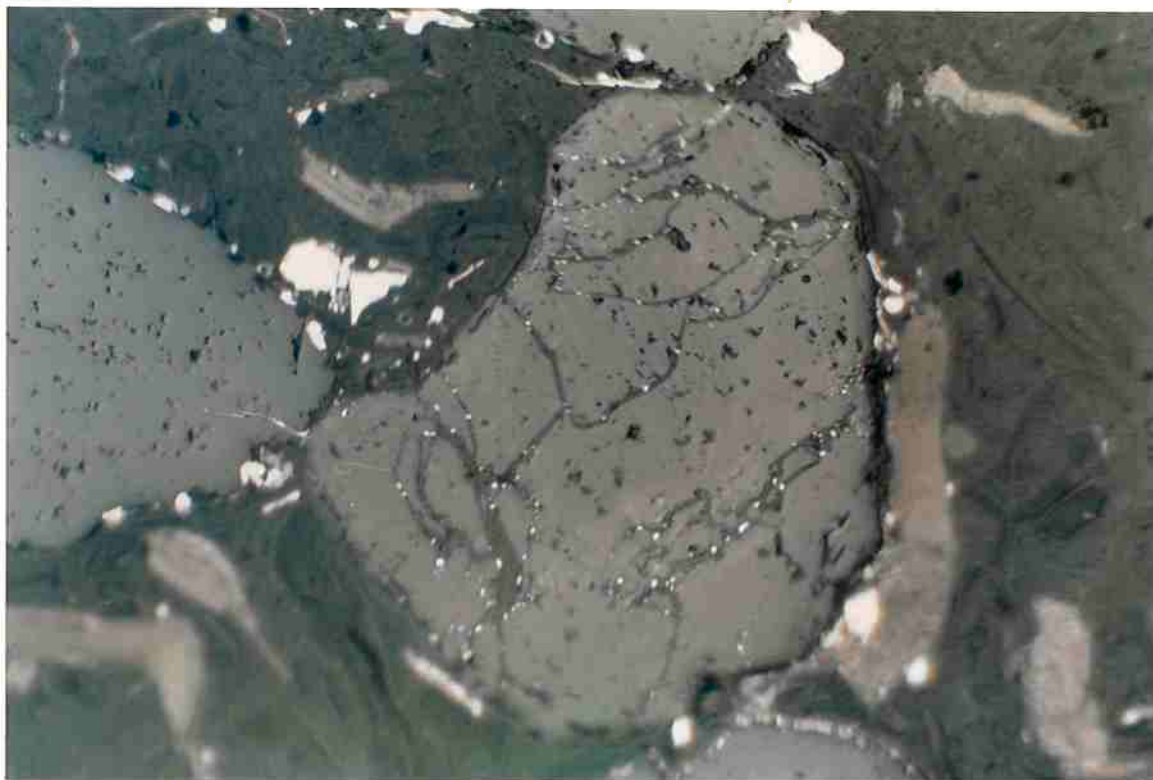
Figura 75: Micrografia óptica da cromita parcialmente reduzida a 16.64%, tempo=20min e aumento 429x.
