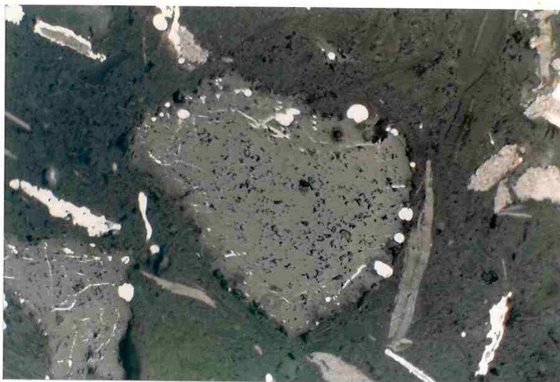
Figura 77: Micrografia óptica da cromita parcialmente reduzida a 37.4%, tempo=80min e aumento 429x.
