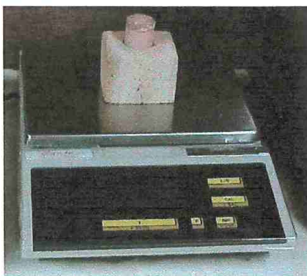
Figura 35: Procedimento de pesagens dos cadinhos recém tirados do FTR.
