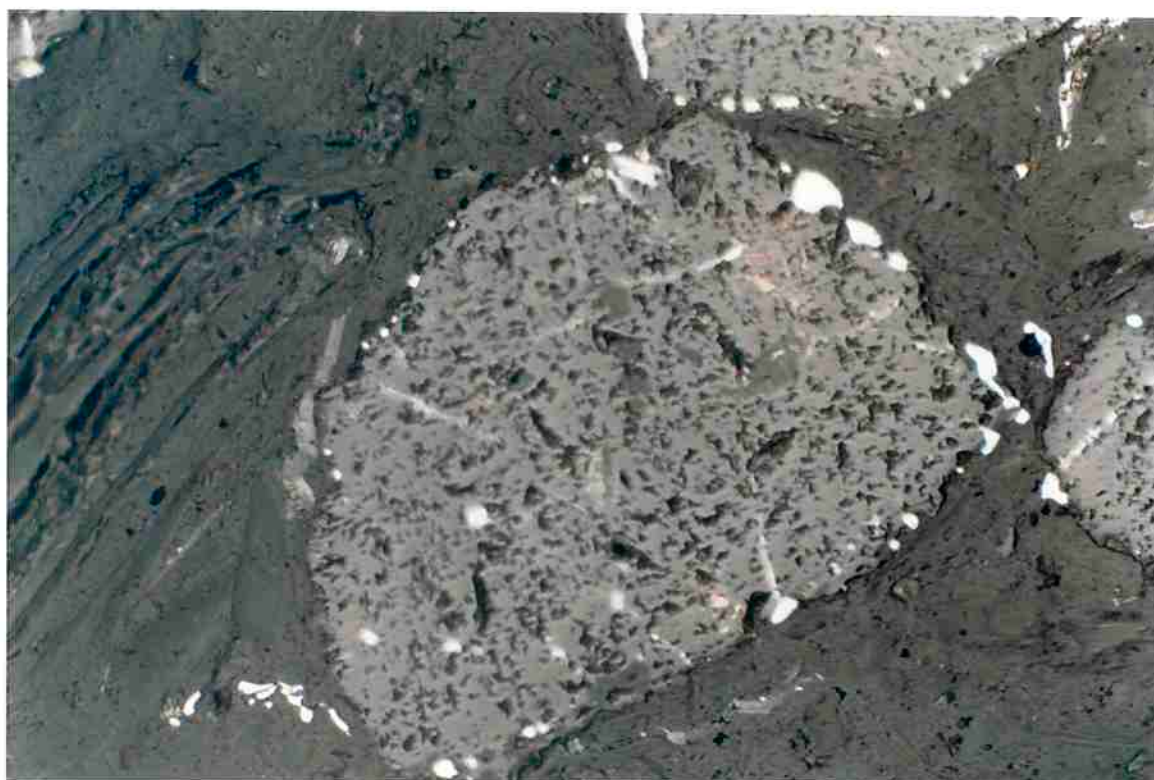
Figura 73: Micrografia óptica da cromita parcialmente reduzida a 30.57%, tempo=120min e aumento 429x.
