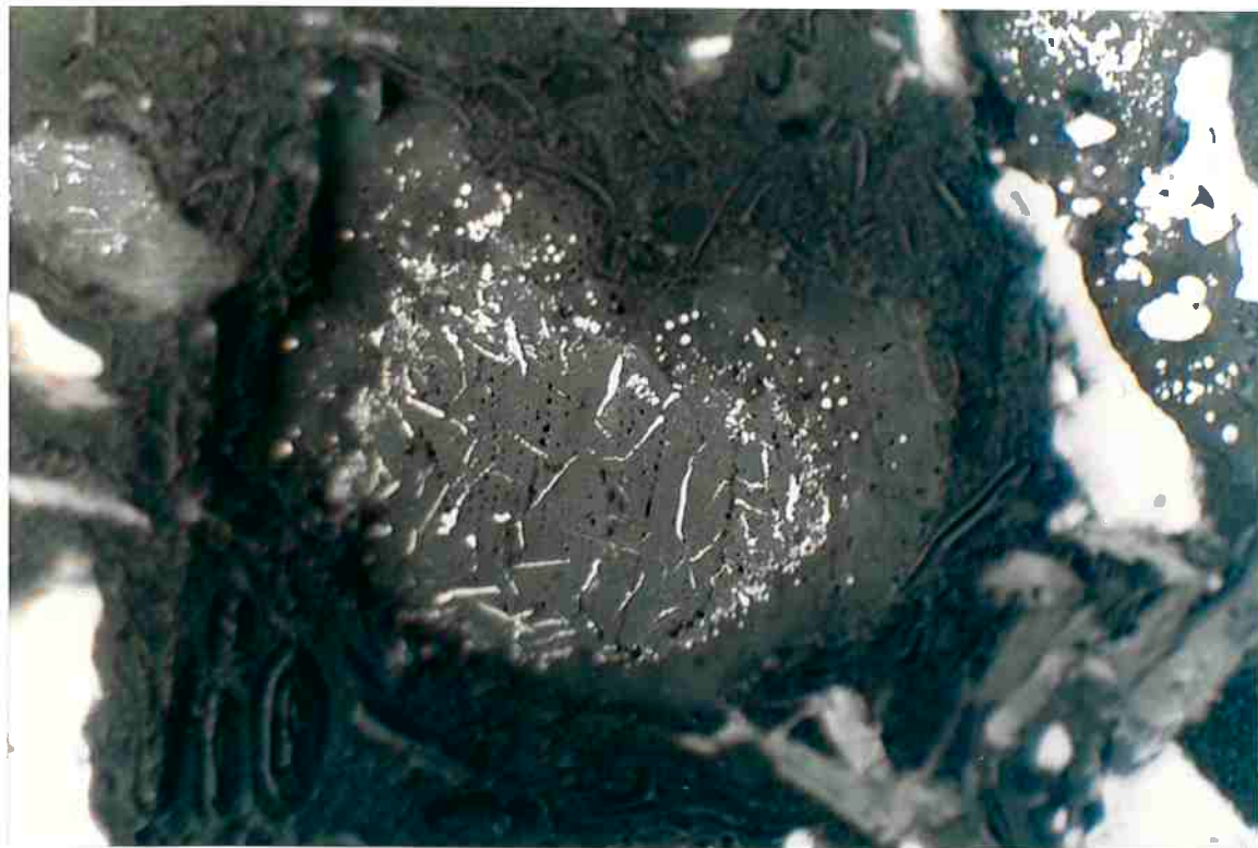
Figura 85: Micrografia óptica da cromita parcialmente reduzida a 83.47%, tempo=120min e aumento 429x.
