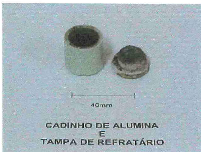
Figura 27: Cadinho de Alumina e tampa de refratário utilizados nos ensaios no forno tubular.
