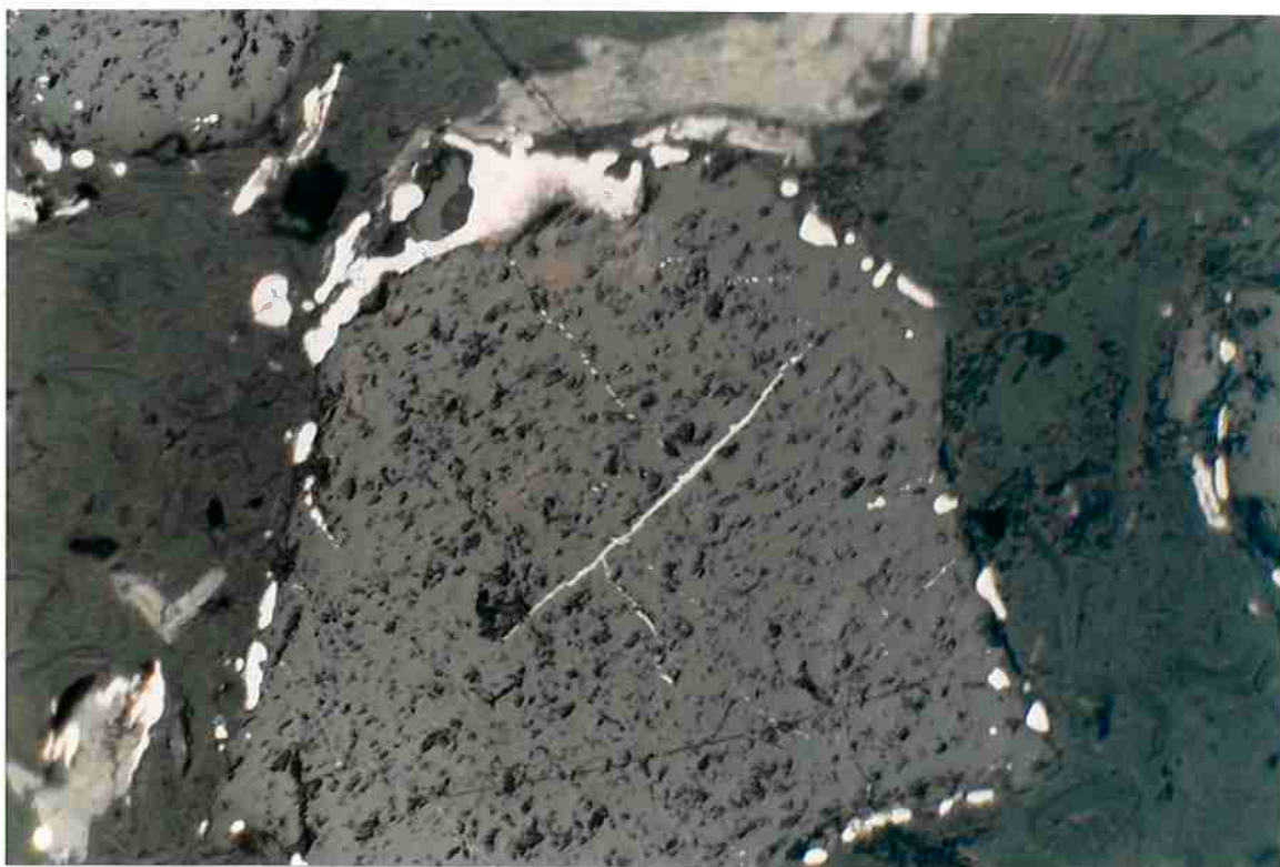
Figura 74: Micrografia óptica da cromita parcialmente reduzida a 36.41%, tempo=200min e aumento 429x.
