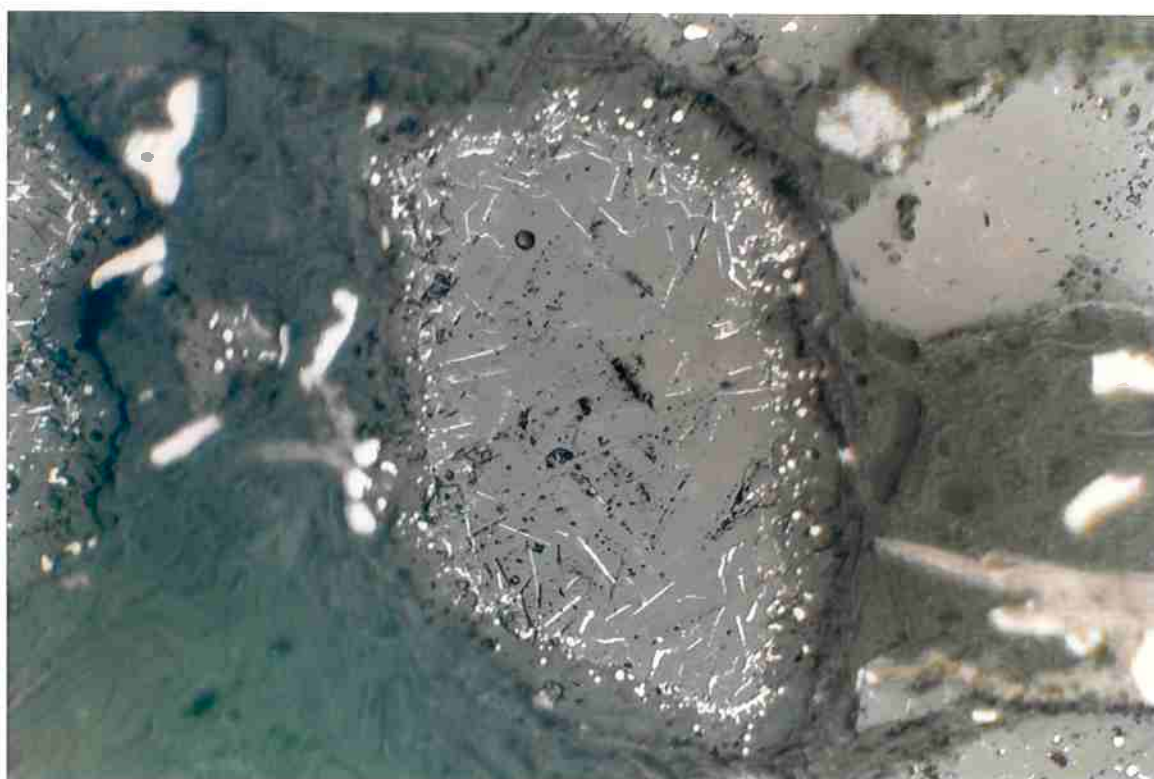
Figura 82: Micrografia óptica da cromita parcialmente reduzida a 74.11%, tempo=200min e aumento 429x.
