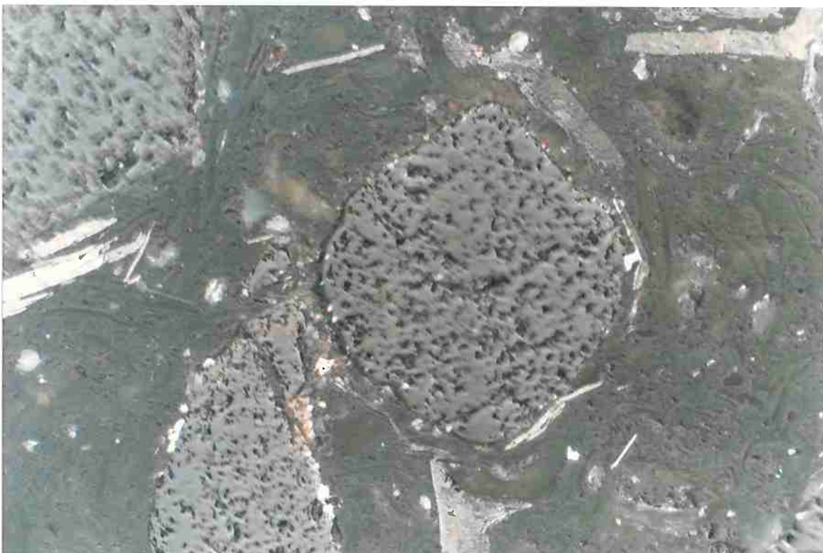
Figura 68: Micrografia óptica da cromita parcialmente reduzida a 11.77%, tempo=60min e aumento 429x.
