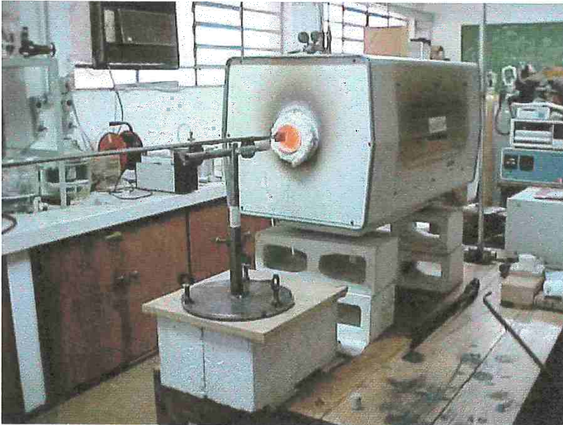
Figura 25: Vista geral do forno a resistência horizontal mais dispositivo de retirada e entrada de amostras.
