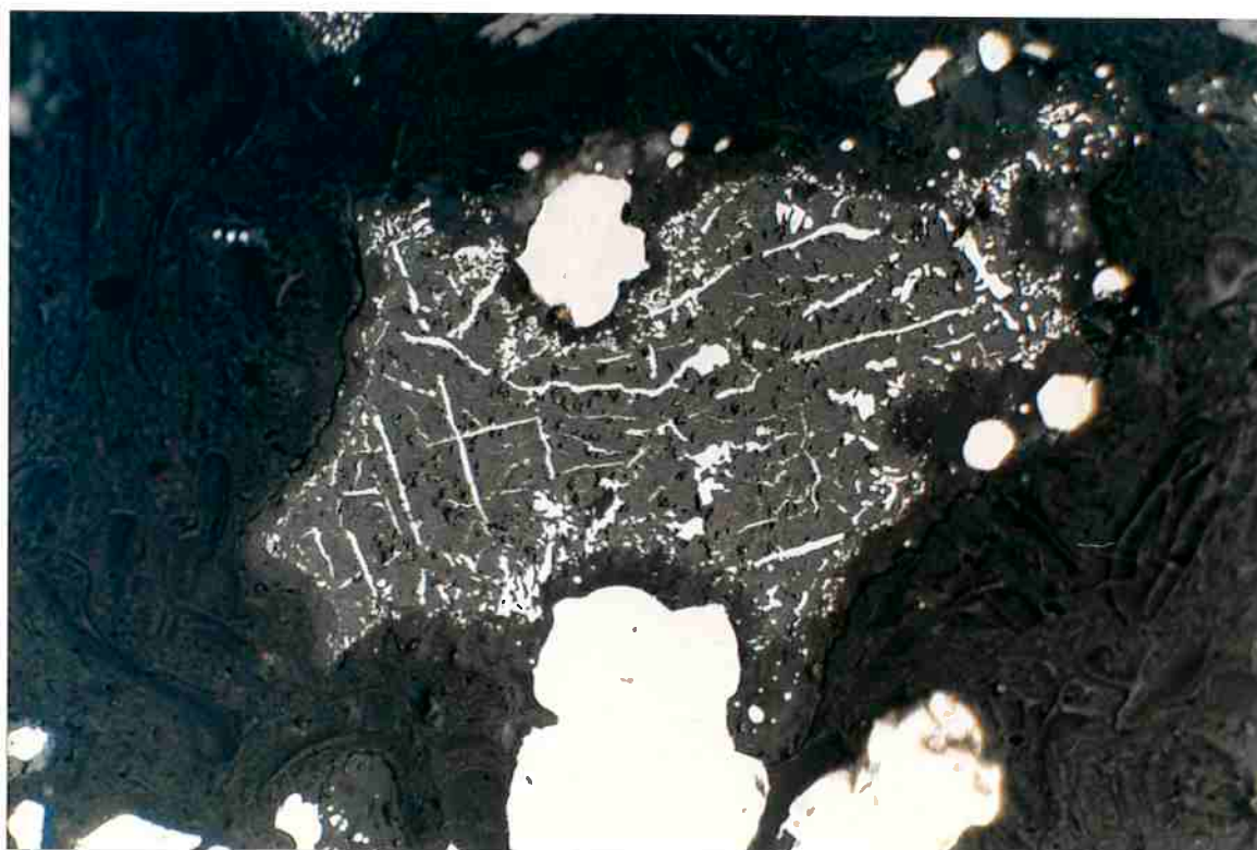
Figura 87: Micrografia óptica da cromita parcialmente reduzida a 89.87%, tempo=200min e aumento 429x.
