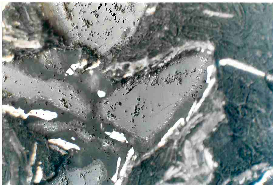
Figura 83: Micrografia óptica da cromita parcialmente reduzida a 36.56%, tempo=20min e aumento 429x.
