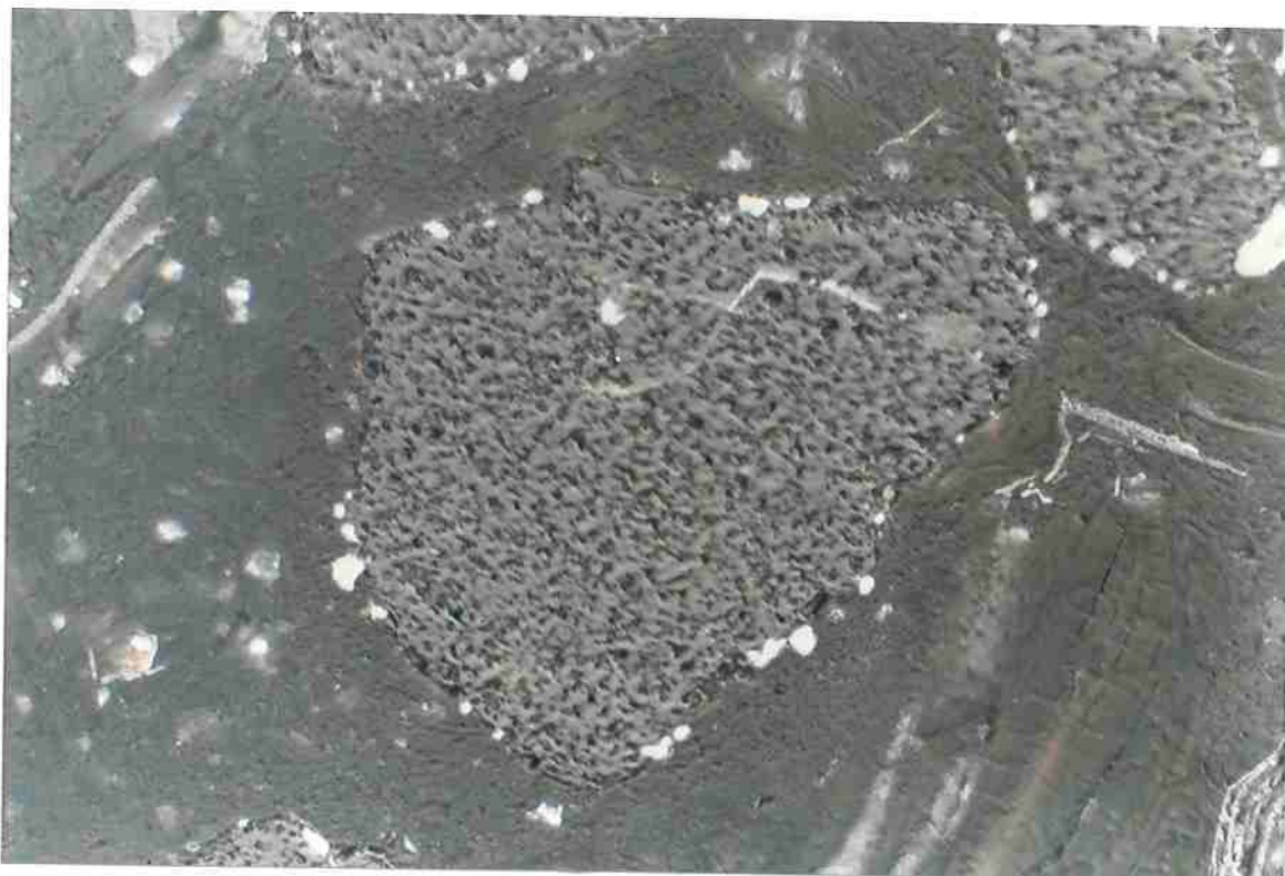
Figura 69: Micrografia óptica da cromita parcialmente reduzida a 23.34%, tempo=140min e aumento 429x.
