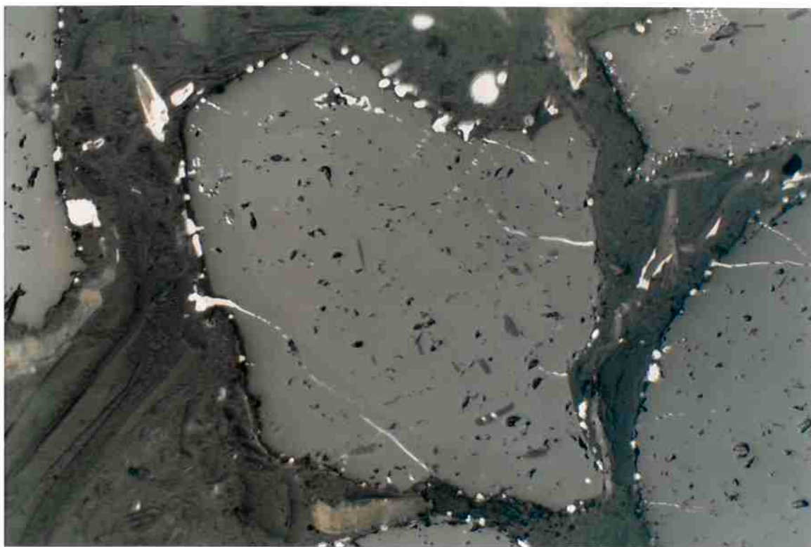
Figura 72: Micrografia óptica da cromita parcialmente reduzida a 23.09%, tempo=60min e aumento 429x.
