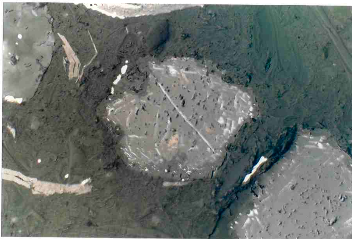
Figura 81: Micrografia óptica da cromita parcialmente reduzida a 61.79%, tempo=120min e aumento 429x.
