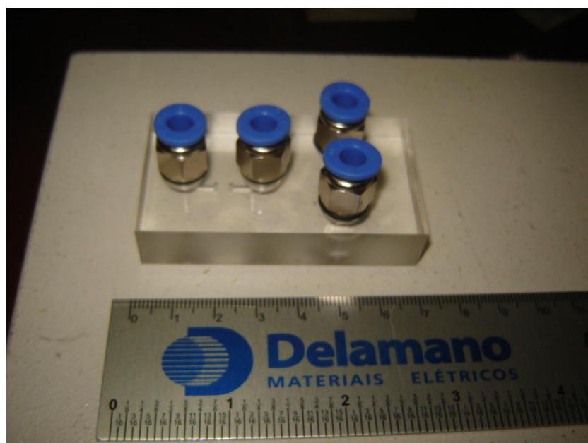
Figura 60 - Peça 2 de circuito "OR" lógico pneumático.
