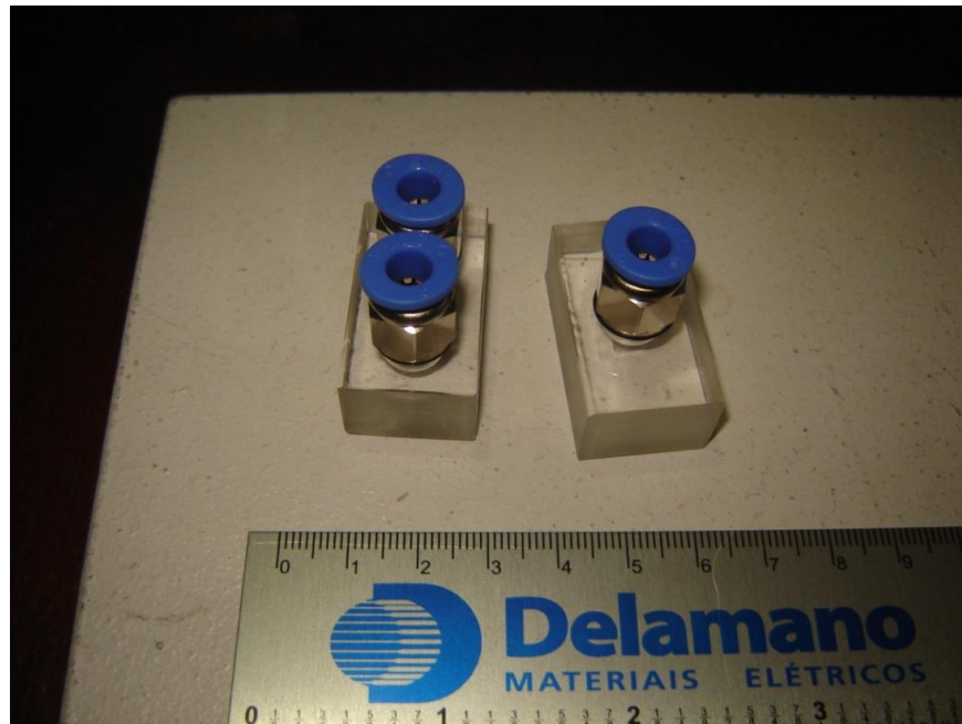
Figura 46 - Peças da válvula NF à vácuo construídas.
