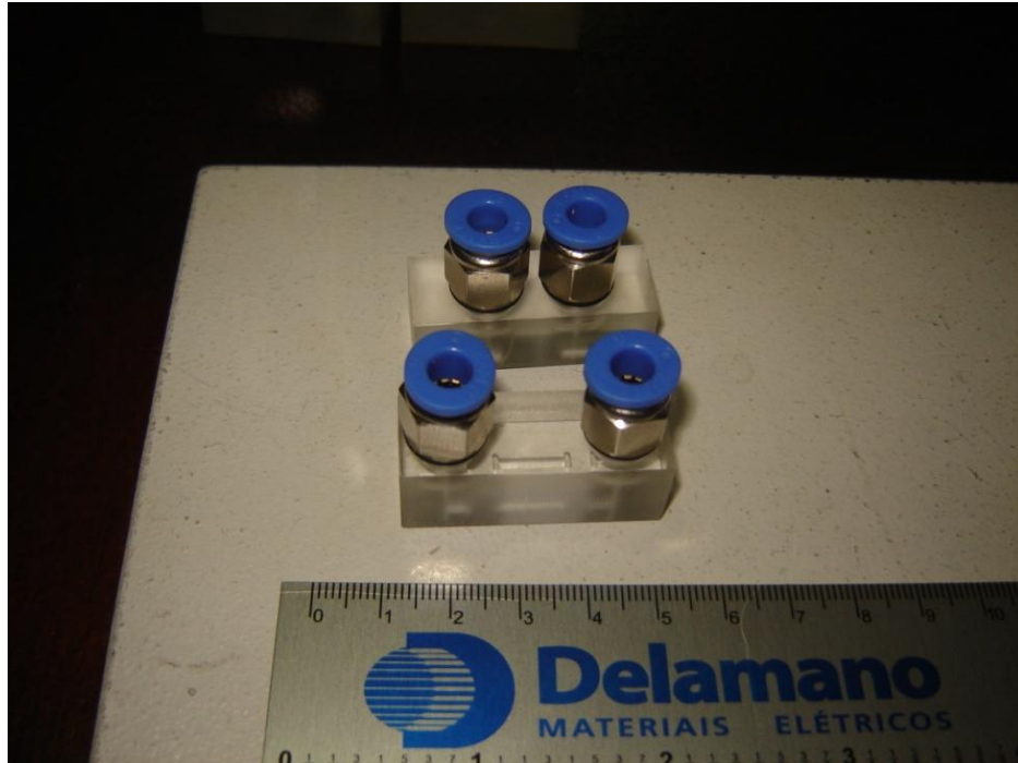
Figura 55 - Peças do circuito "AND" lógico.
