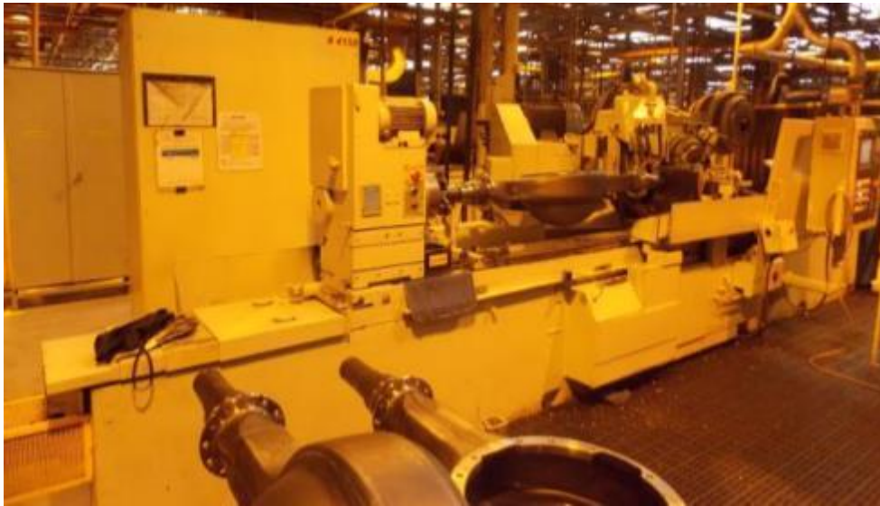
FIGURA 25 - RETIFICA CILÍNDRICA ANGULAR USINANDO A CARCAÇA DO EIXO DE TRAÇÃO – VISTA FRONTAL
