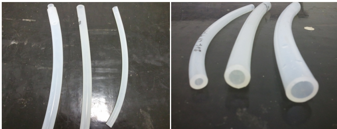
Figura 9. Exemplos de membranas de silicone utilizadas para a microaeração. Fonte: Camiloti (2015)
