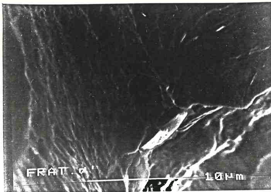
Figura 13 - Fratura da amostra contendo fase alfa linha, 4000 x de aumento, elétrons retroespalhados.
