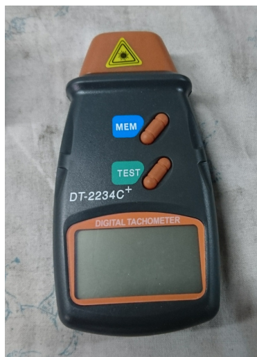
Figura 24: Tacômetro digital DT-2234C+.
