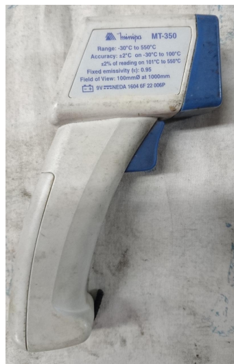
Figura 25: Termômetro infravermelho modelo MT-350 da marca Minipa.
