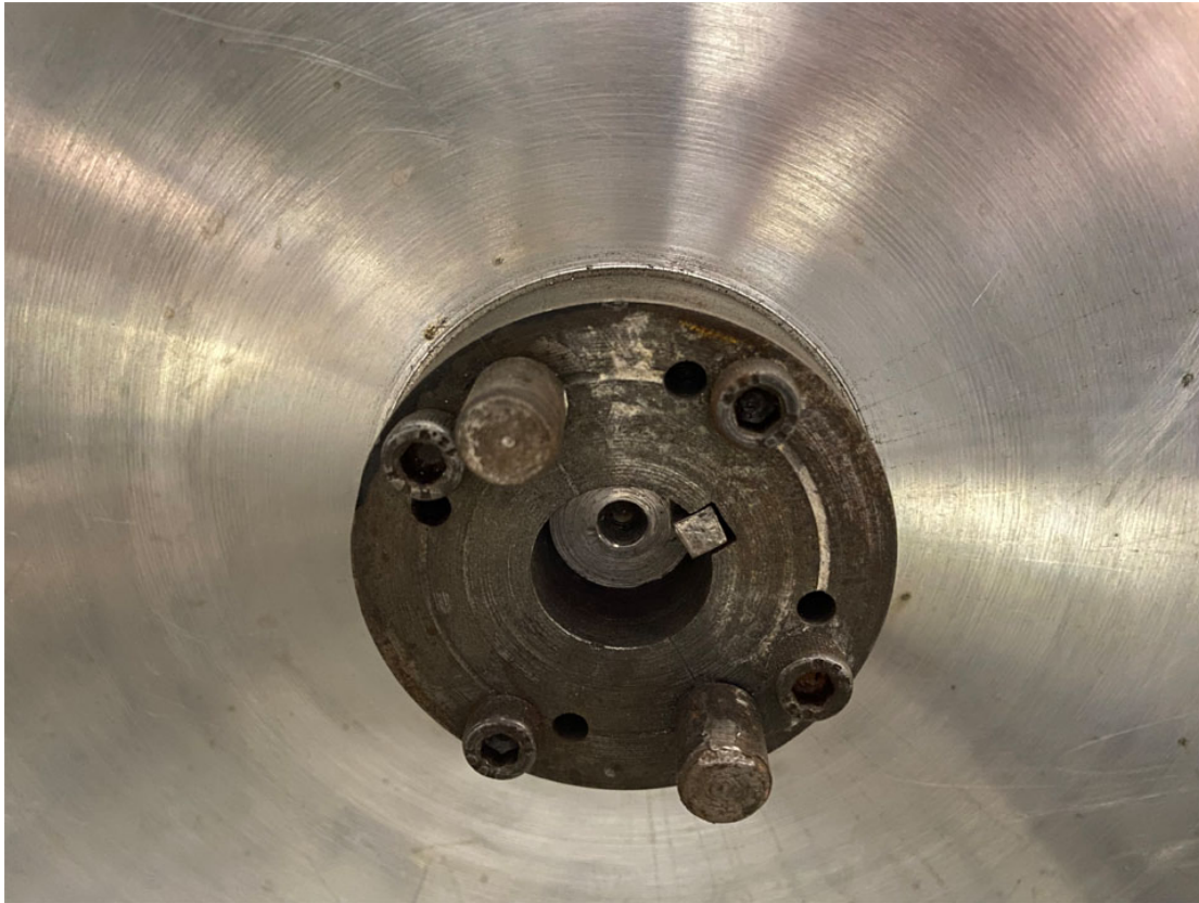
Figura 15: Fixação do eixo no disco de alumínio.
