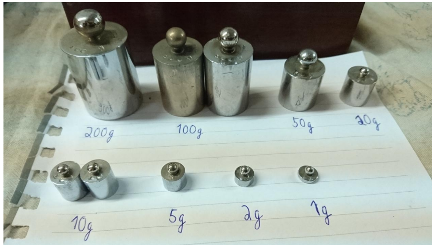
Figura 21: Pesos utilizados para calibração da célula de carga.
