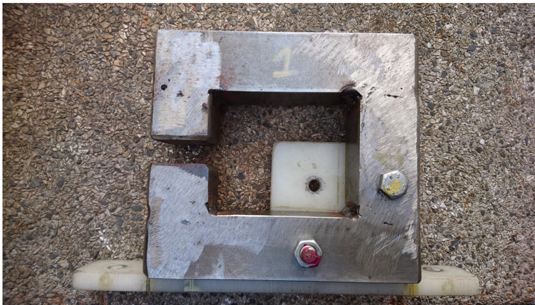
Figura 18: Vista superior do núcleo de ferro do eletroímã.
