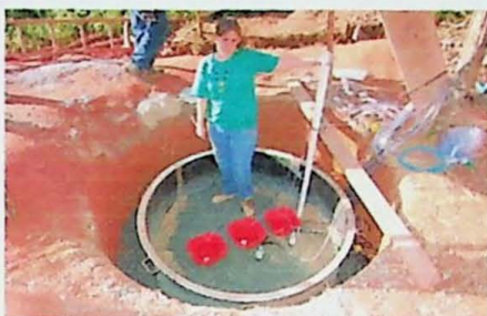
Figura 4.25 Posicionamento do último nível de instrumentos
