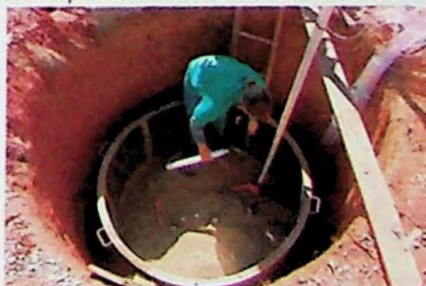
Figura 4.22 Instalação do amostrador de gases na base da camada 5
