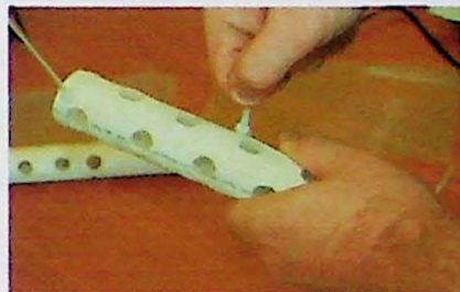
Figura 2.4 Fixação da tela com braçadeiras.
