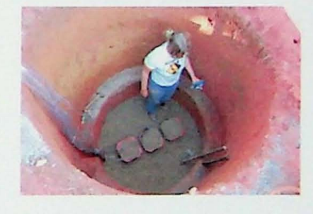
Figura 6.8 Instrumentos entre as camadas 5 e 6
