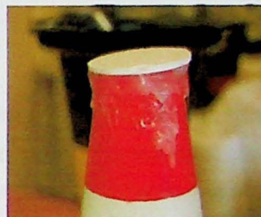
Figura 2.2 Base menor colada com folha de PVC.
