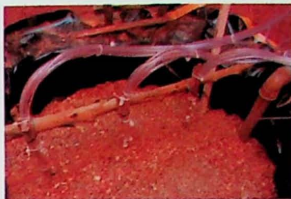
Figura 4.12 Instalação dos piezômetros, guiados através de um pedaço de tronco já na mistura com a serragem
