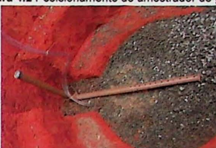
Figura 4.4 Posicionamento do dreno inferior
