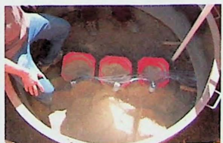
Figura 4.21 Disposição final dos lisímetros na base da camada 5
