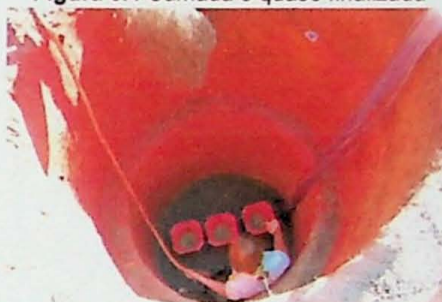
Figura 6.6 Instalação dos lisímetros.
