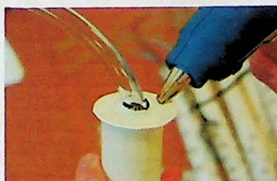
Figura 2.5 Finalização do filtro com colagem de folha de PVC e mangueira para sucção de amostra.
