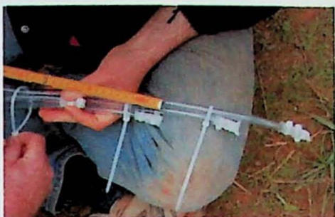
Figura 4.11 Espaçamento entre os piezômetros para a posição do centro (C)
