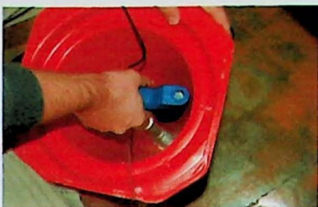
Figura 2.7 Filtro sendo colado com silicone quente dentro do cone de PE.
