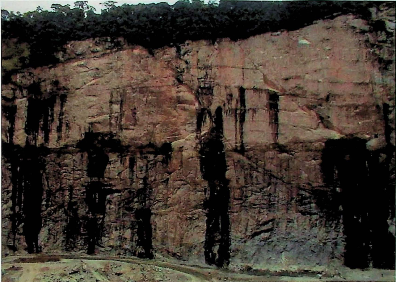
Foto 9 – Vista geral do talude maior da Pedreira Itacema. Notar descontinuidades bastante persistentes e com percolação d'água. Granito
