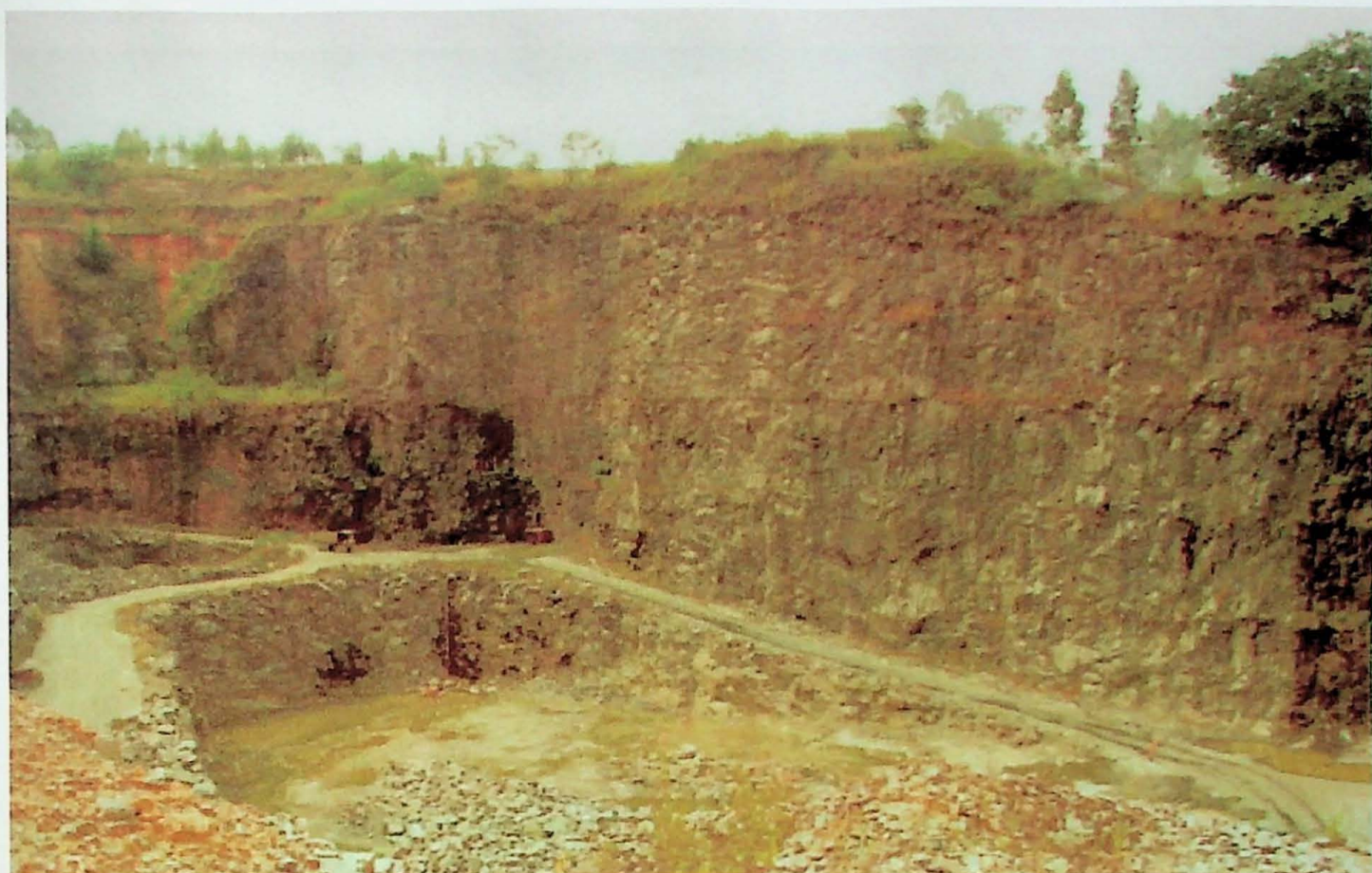
Foto 13 – Vista Geral da Pedreira Cavinato – Diabásio. Notar fraturamento vertical menos espaçado e horizontal bastante espaçado.
