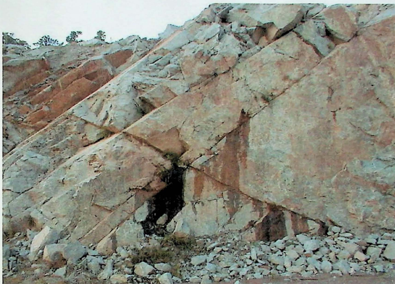
Foto 7 – Detalhe de sistema de juntas, apresentando percolação d'água – Pedreira Embu – Granito
