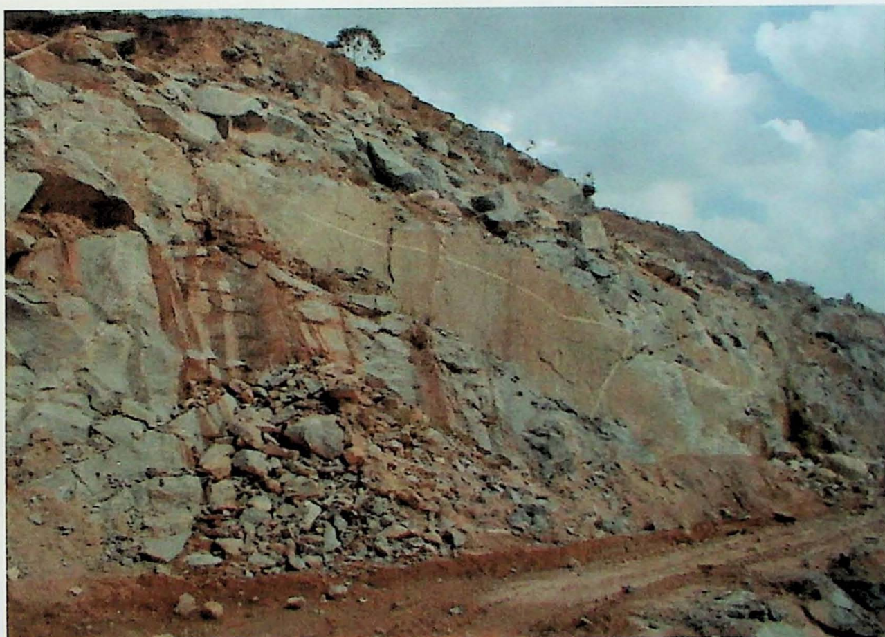
Foto 4 – Detalhe de plano sub-vertical, bastante persistente, cortando vários taludes – Pedreira Construcap – Granito
