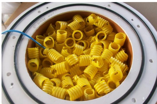
Figura 4.2 Detalhe da câmara intermediária com ênfase no preenchimento com conduítes de plástico. Marcon (2011).
