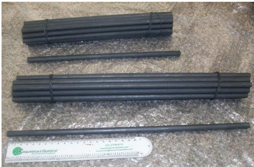
Figura 4.3 Barras de grafite utilizadas como eletrodos na CCM Marcon (2011)
