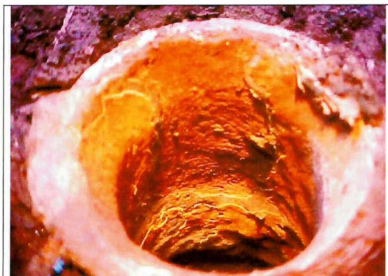
Figura 26 – Tubo incrustado devido aos sais contidos na água
