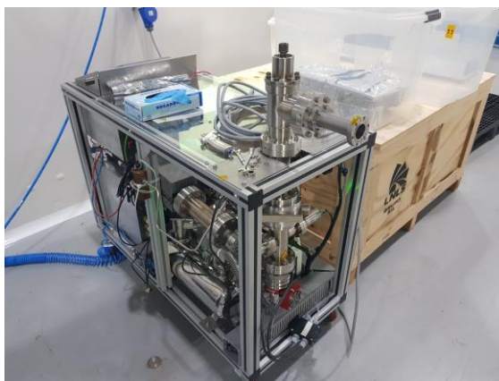
Figura III-23: Estação de bombeamento de alto vácuo equipada com espectrômetro RGA200 para análise de gases residuais [Fonte: autor].
