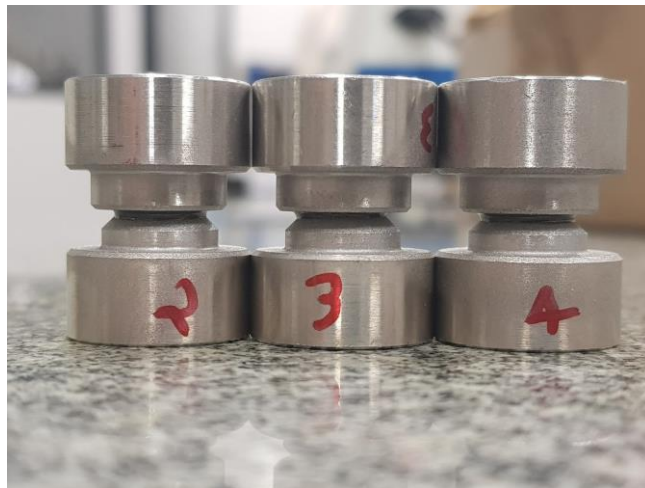
Figura III-15: Pinos de Invar 39 colados para ensaio de adesão Invar-Invar [Fonte: autor].
