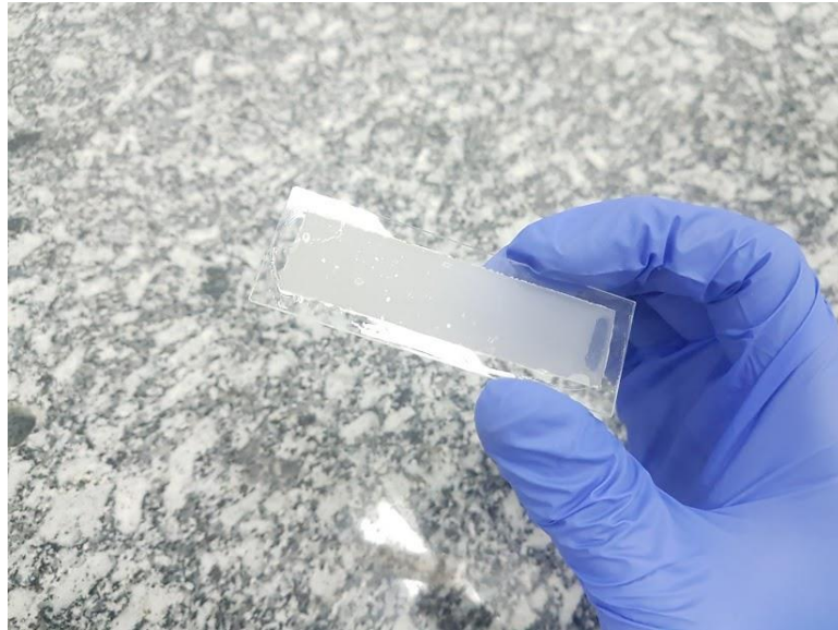
Figura IV-10: Lâmina de vidro com resina 42HT-2LO após teste de RGA [Fonte: autor].
