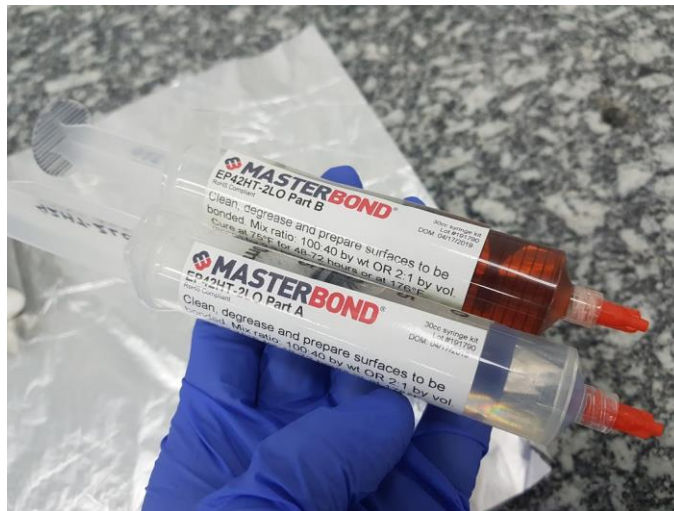
Figura III-4: Seringas com as partes A e B da cola MasterBond 42HT-2LO [Fonte: autor].
