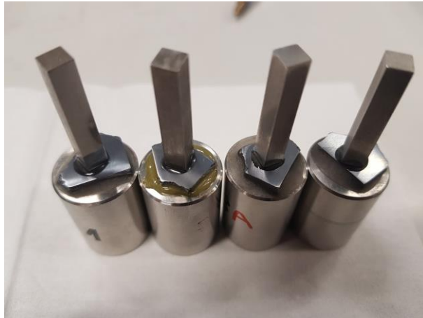
Figura III-10: Pinos de Invar colados em retalhos de silício [Fonte: autor].
