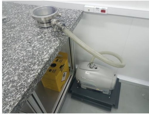
Figura III-6: Sistema de vácuo construído para remoção de bolhas de ar das amostras de adesivo [Fonte: autor].
