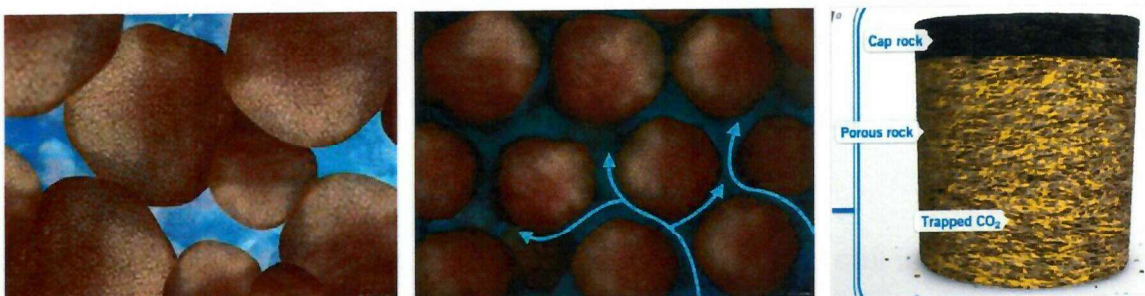
Figura 2.27 – Características físicas para armazenamento geológico de \text{CO}_2 (porosidade, permeabilidade e barreira de confinamento)
