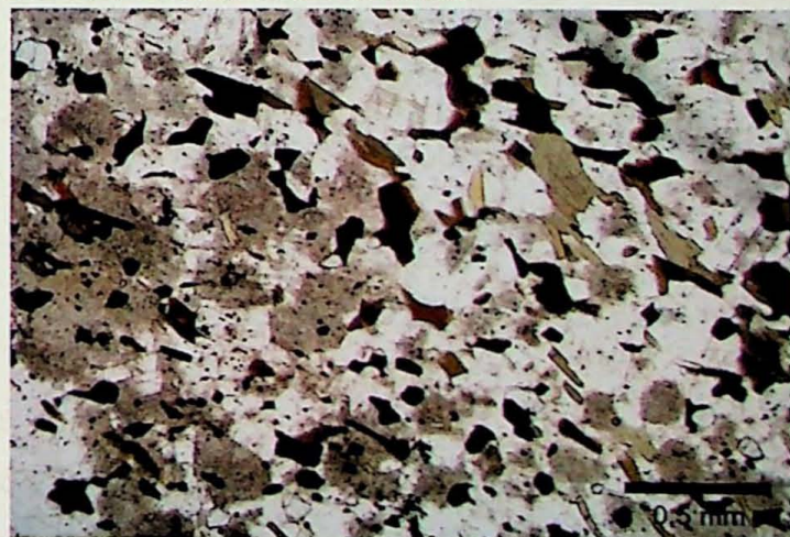
Fotomicrografia 22 (PB-209D): Enclave microgranular máfico de textura metamórfica granoblástica. Minerais essenciais: Plagioclásio, biotita, minerais opacos e quartzo.
