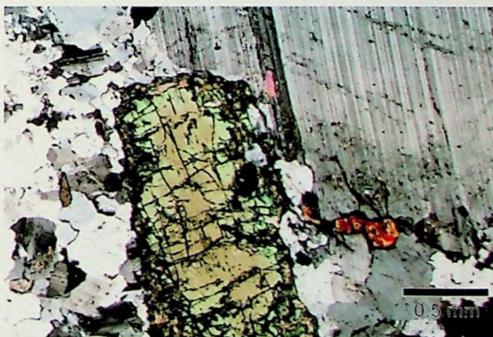
Fotomicrografia 28 (PB-186B): Egrina-augita zonada com bordas corroídas e associada ao plagioclásio com geminação polissintética.
