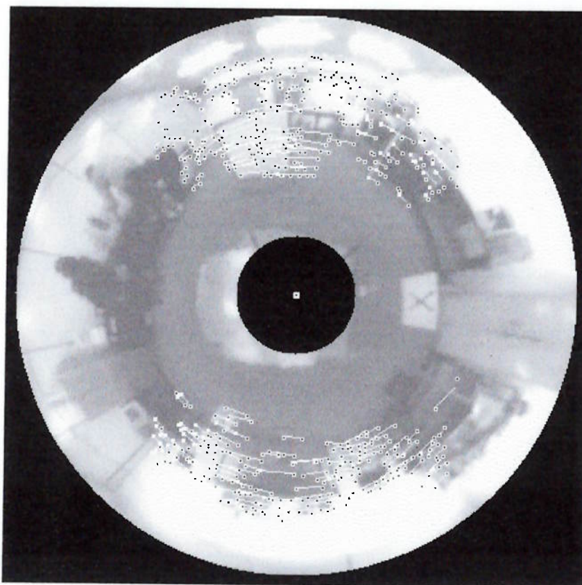
Figura 42 - Matching de Pontos - Deslocamento de 20 cm
