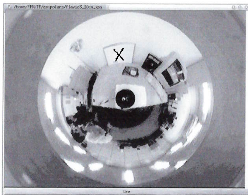
Figura 23 - Imagem omnidirecional com os epipólos obtidos
