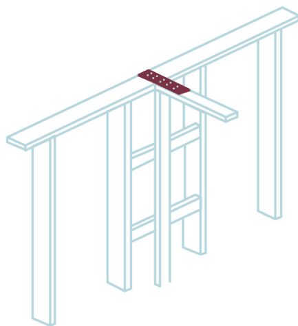
vista em corte da conexão entre laje seca e painel de parede em wood frame
