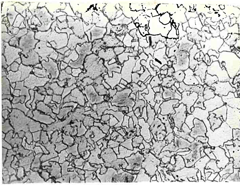
Fig.17 - Amostra 01 - borda. Ferrita e perlita. Resfriamento em água. Delay time : 1'40"
