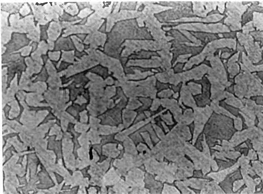
Fig. 34 - Amostra 09 - centro. Ferrita e perlita. Resfriamento em água. Delay time : 2'20"
