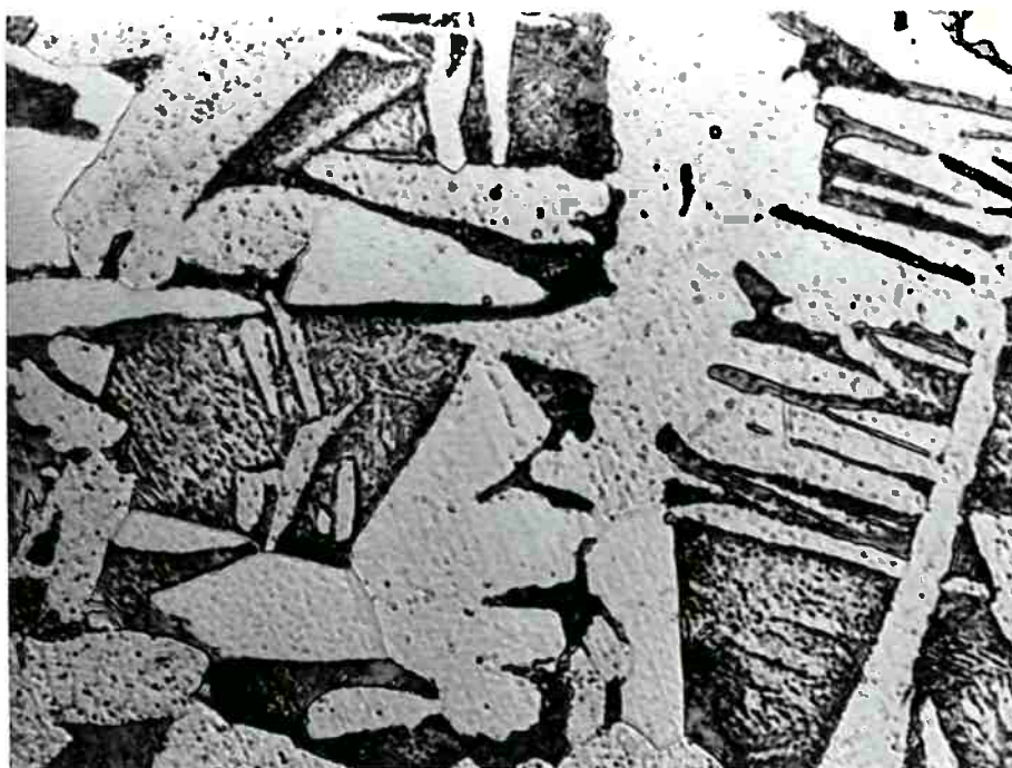
Fig.38 - Amostra 11 -centro. Ferrita e perlita. Resfriamento em areia. Delay time : 1'40"
