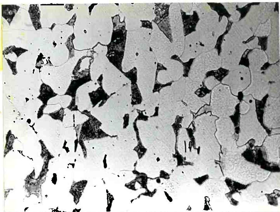
Fig.39 - Amostra 12 - borda. Ferrita e perlita. Resfriamento em ar.
