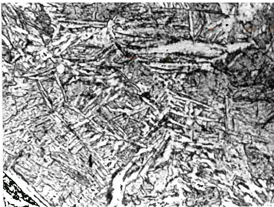
Fig. 18 - Amostra 01 - centro. Ferrita acicular, bainita e constituinte fino, que é uma mistura de ferrita e carboneto, formado no resfriamento em água (provavelmente bainita) . Resfriamento em água. Delay time : 1'40"
