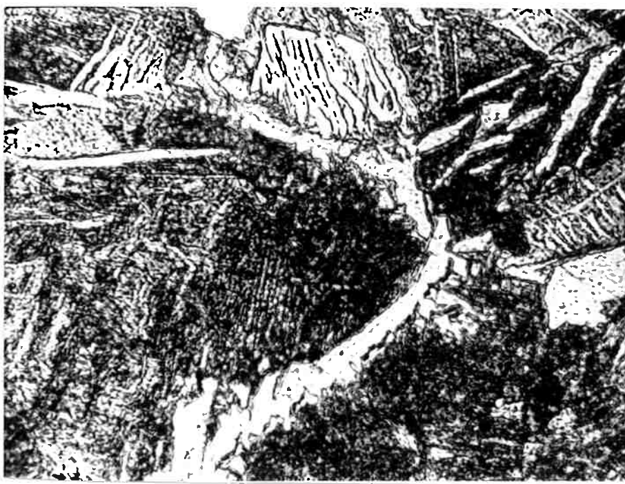
Fig. 30 - Amostra 7 - centro. Ferrita, perlita e constituinte fino, que é uma mistura de ferrita e carboneto, formado no resfriamento em água (provavelmente bainita). Resfriamento em água. Delay time : 1'40"
