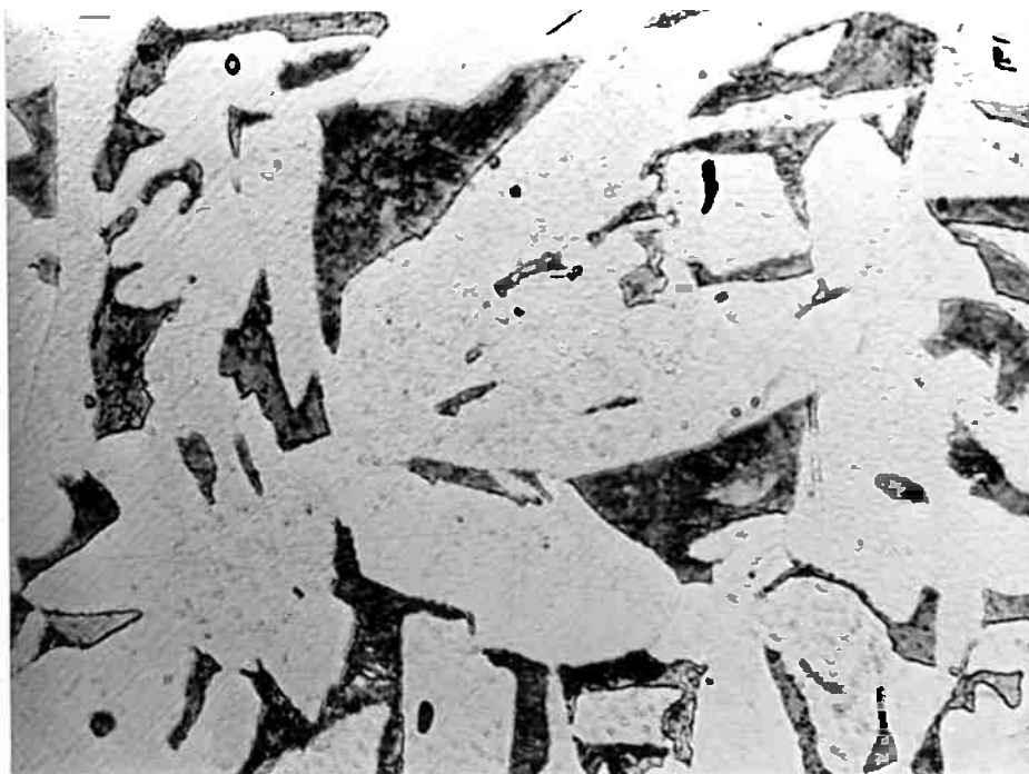
Fig.36 - Amostra 10 - centro. Ferrita e perlita. Resfriamento em água. Delay time : 2'40"
