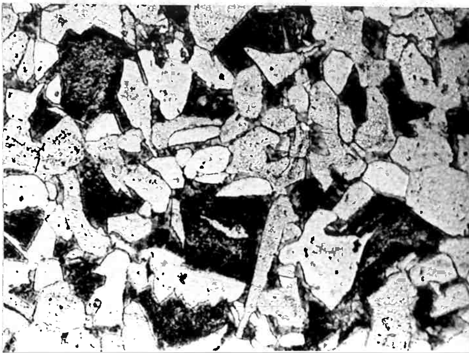
Fig. 29 - Amostra 07 - borda. Ferrita e perlita. Resfriamento em água. Delay time : 1'40"
