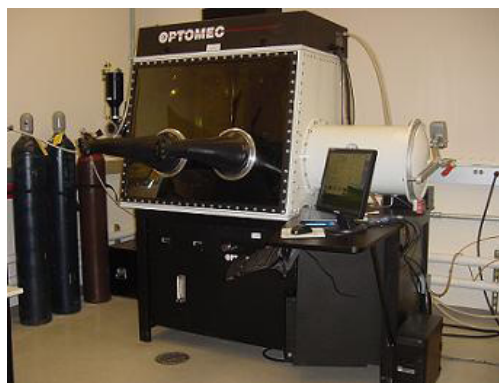
Fig. 22 - Máquina de RP que produz protótipos metálicos. FONTE: http://www.mme.wsu.edu/
