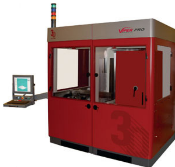
Fig.16 – Máquina de prototipagem de que utiliza a técnica da estereolitografia. FONTE: http://en.wikipedia.org/
