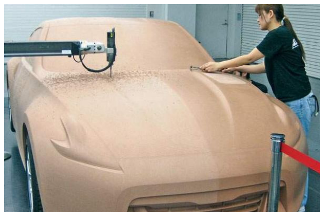
Fig.11 - Confeção do modelo em clay através do uso da máquina e acabamento manual. FONTE: http://4.bp.blogspot.com/_q3sArtfjCzA/TTYc-uu_1ul/AAAAAAAAAEM/asWwea13Bpl/s1600/autonews.nissan.z.clay_610x398.jpg
