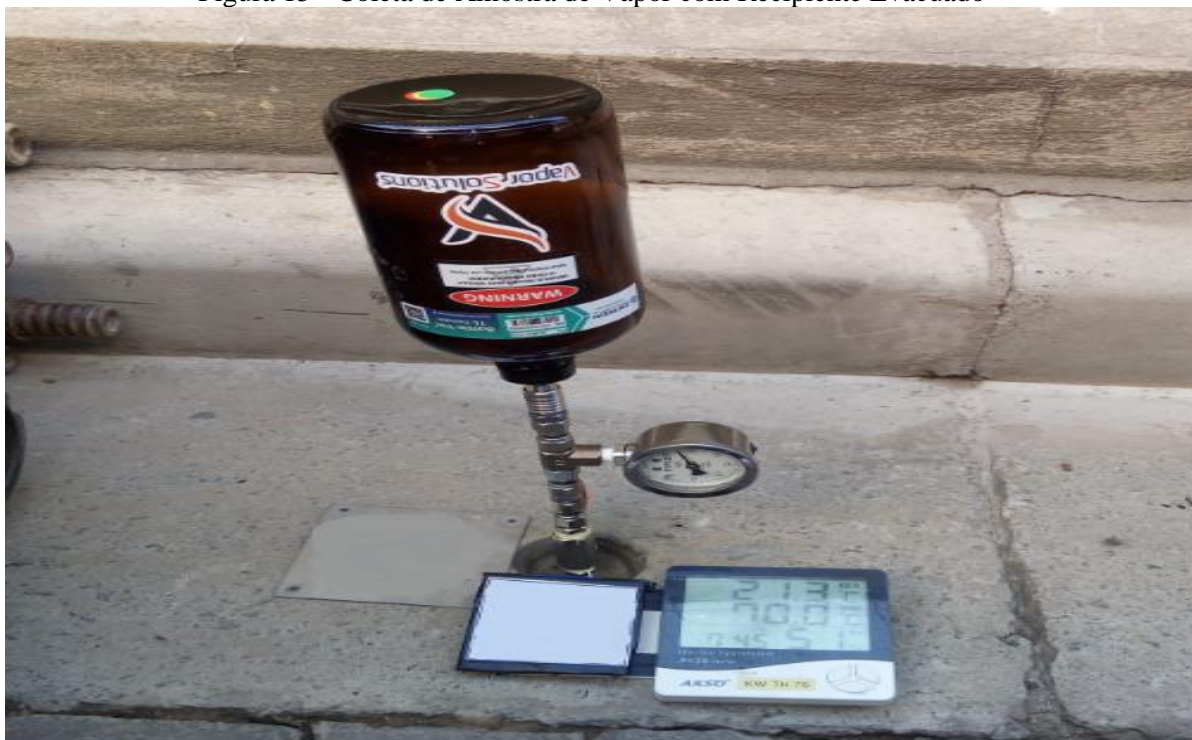
Figura 15 - Coleta de Amostra de Vapor com Recipiente Evacuado
