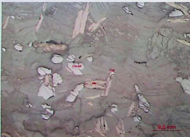
Fotomicrografia 5: Vm-88-04Bt – Região enriquecida em molibdenita difusa na matriz rica em flogopita, opacos são cromita, magnetita e calcopirita.
