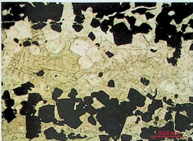
Fotomicrografia 7: 7Jclp – Cromititos com veios serpentínicos.
