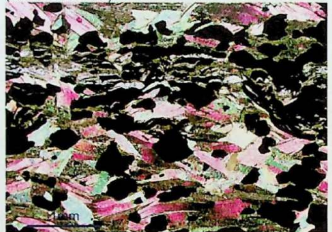
Fotomicrografia 4: Vm-88-04 – Piroxenito metassomatizado com porção enriquecida em flogopita.
