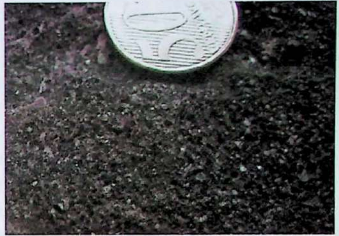
Foto 10: Cromitito grosso com cristais euhédricos bem desenvolvidos.
