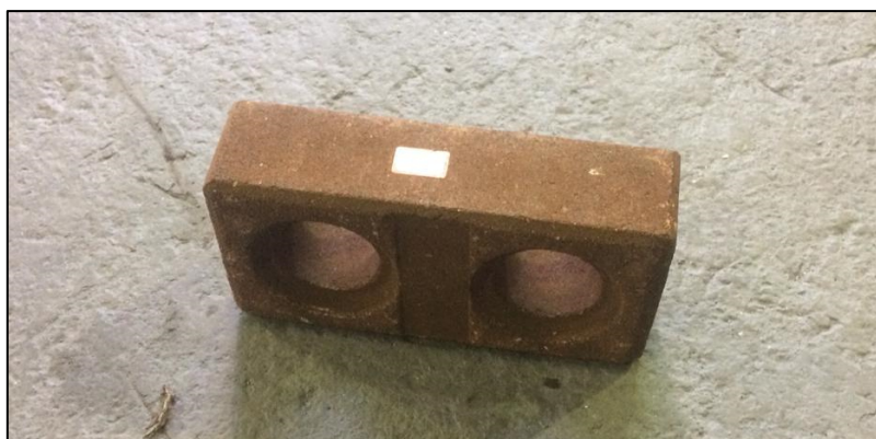
Figura 30 – Tijolo fabricado com 50% de resíduo do processo da gaseificação
