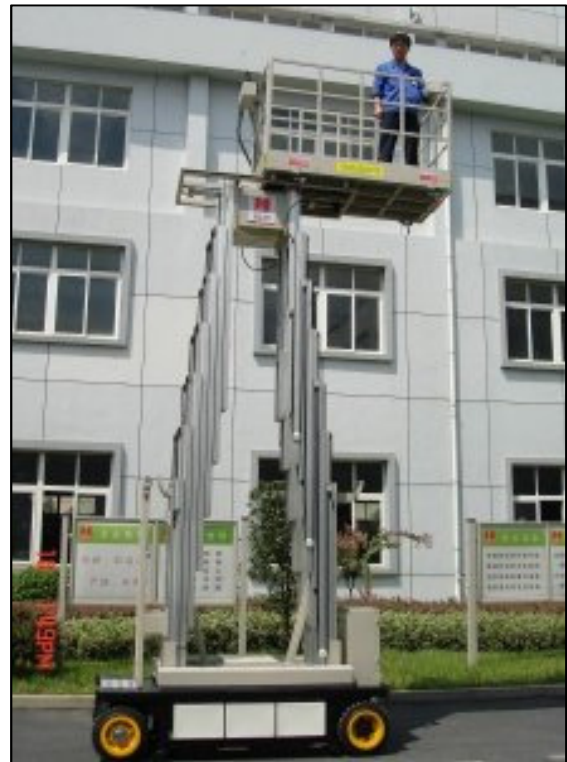
Figura 11: modelo de plataforma auto propelida. Fonte: Lematt, 2012.
