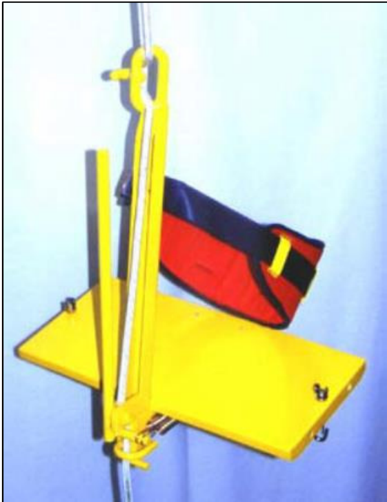
Figura 38: cadeira suspensa com dispositivo de descida. Fonte: MTE, 2008.
