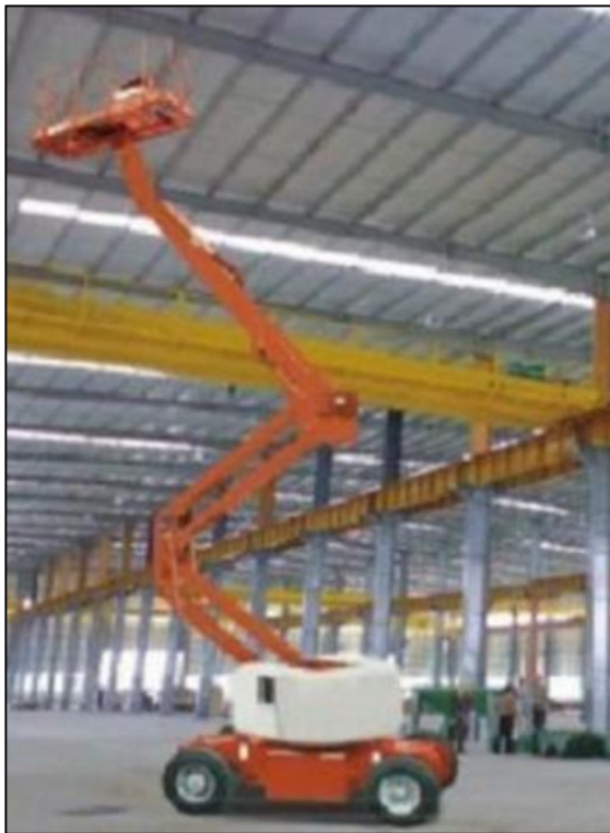
Figura 10: modelo de plataforma articulada. Fonte: Lematt, 2012.
