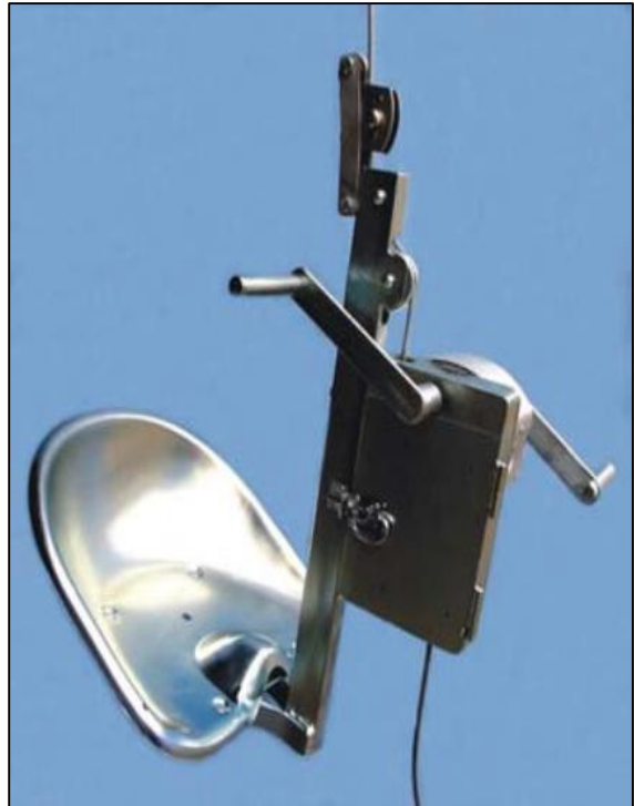
Figura 39: cadeira suspensa com dispositivo de subida e descida. Fonte: MTE, 2008.
