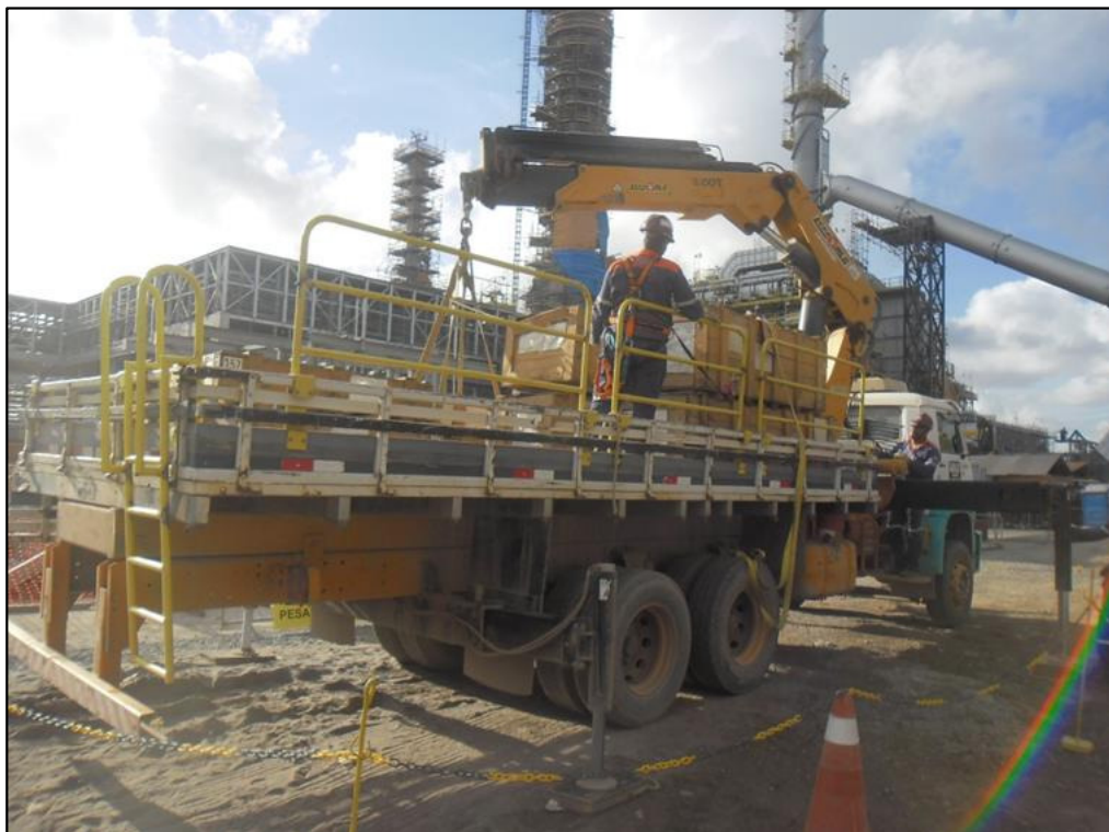
Figura 53: guarda-corpo utilizado em caminhão munck. Fonte: Arquivo pessoal, 2012.
