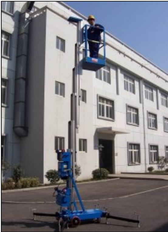
Figura 14: modelo de plataforma mastro único. Fonte: Lematt, 2012.
