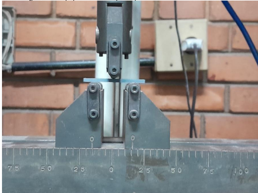
Figura 14 – equipamento e corpo de prova de ensaio de flexão
