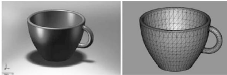
Figura 1 – Transformação de arquivo de CAD em STL.
