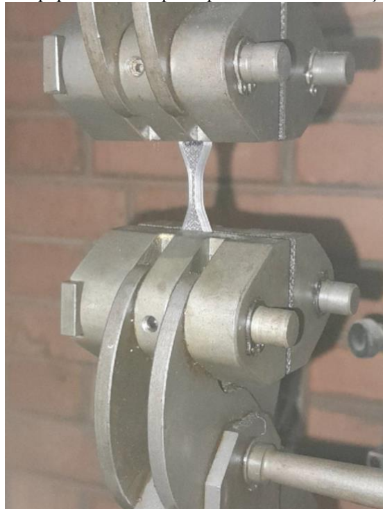
Figura 13 – Equipamento e corpo de prova de ensaio de tração
