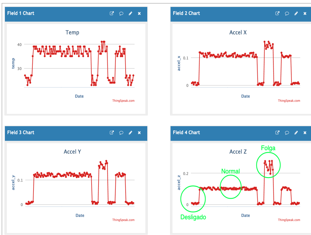
Figura 18 - Coletas de vibração e temperatura realizadas pelo sensor
