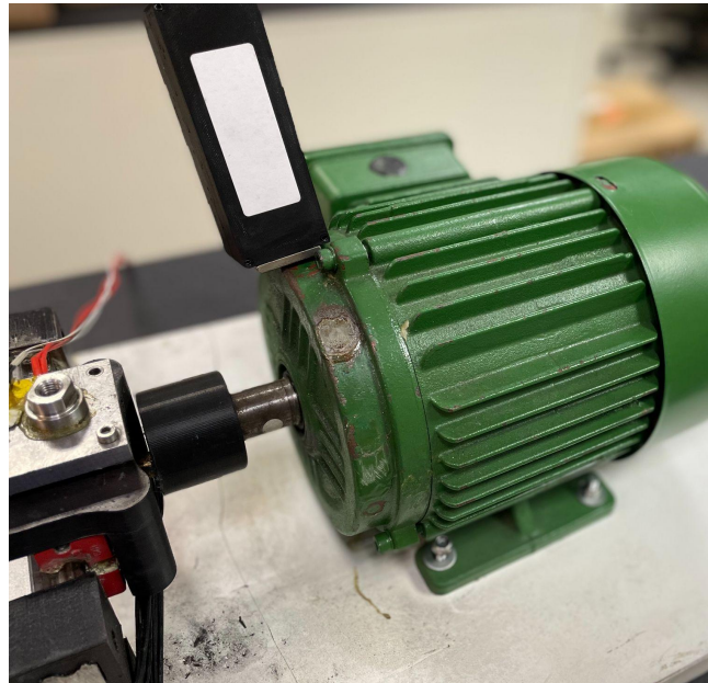
Figura 16 - Fixação do sensor no motor
