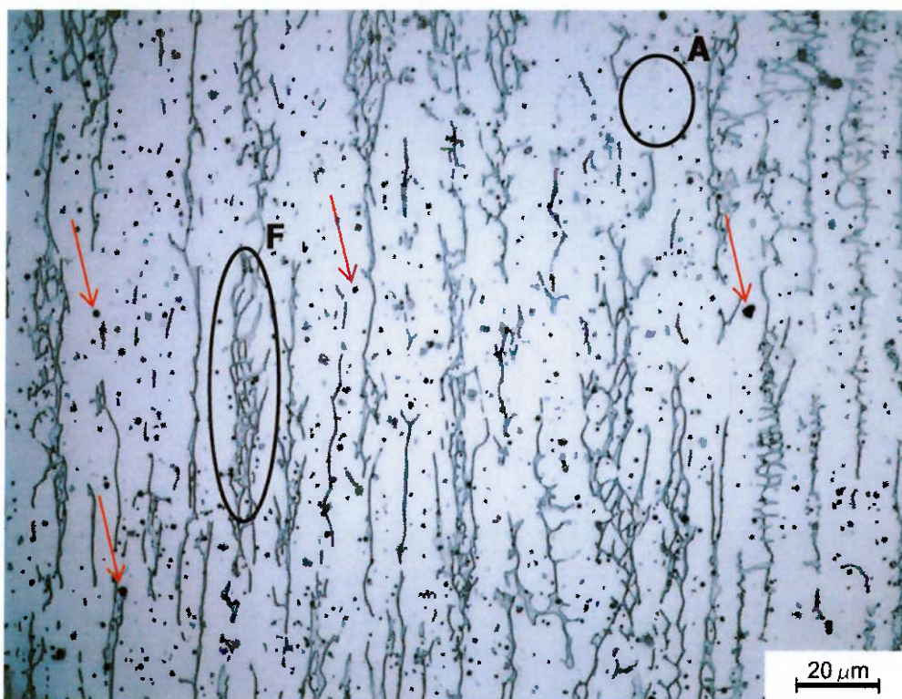
Figura 5.15 - Região da camada do revestimento CP1 com ilhas de ferrita (F) em uma matriz austenítica (A) e uma grande dispersão de pontos de escória indicados por setas na cor vermelha. H 2 C 2 O 4 2H 2 O 10%. Aumento 500X.
