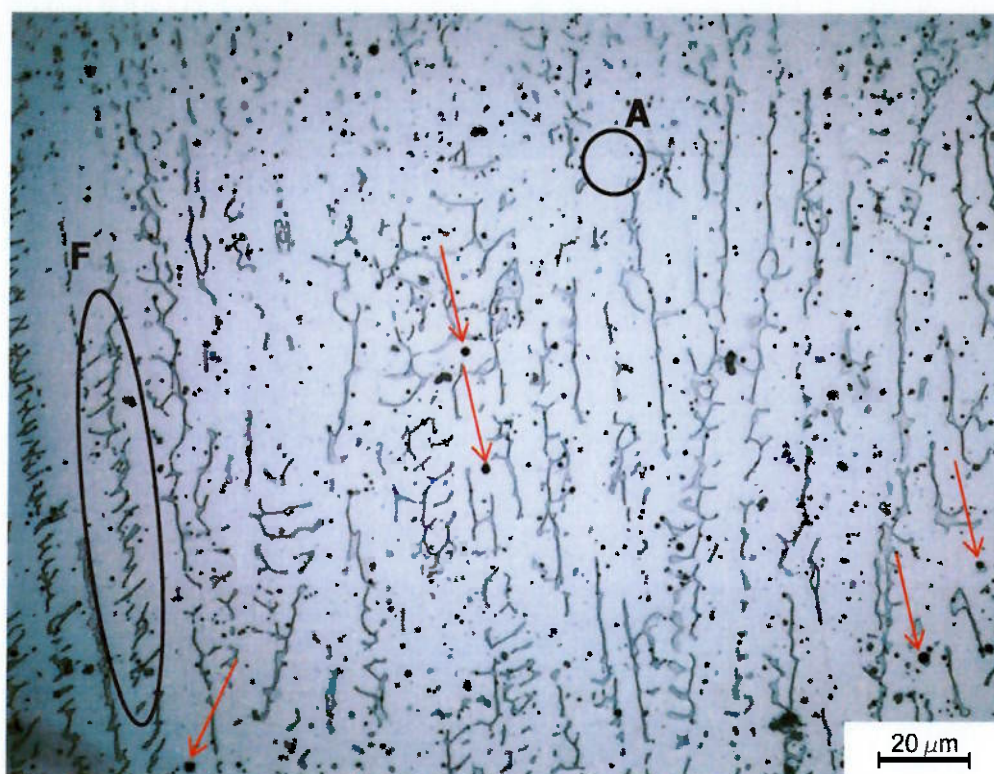
Figura 5.16 - Região da camada do revestimento CP2 com ilhas de ferrita (F) em uma matriz austenítica (A) e uma grande dispersão de pontos de escória indicados por setas na cor vermelha. \text{H}_2\text{C}_2\text{O}_4 \cdot 2\text{H}_2\text{O} 10%. Aumento 500X.
