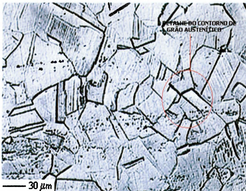
Figura 2.10 - Aço AISI 304, detalhe da estrutura solubilizada, contorno de grãos bem definidos sem precipitação de carbonetos [4].
