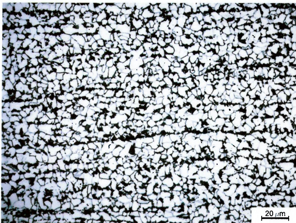
Figura 5.12 - Microestrutura da região central da ZAC do CP2 mais próxima do metal de revestimento. Nital 2%. Aumento 500x.
