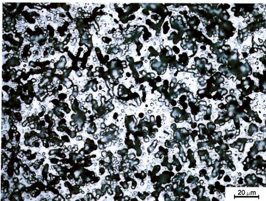
Figura 5.28 - Microestrutura do CP2 da região de 5,0 mm após a realização do ensaio de resistência à corrosão Prática A.
