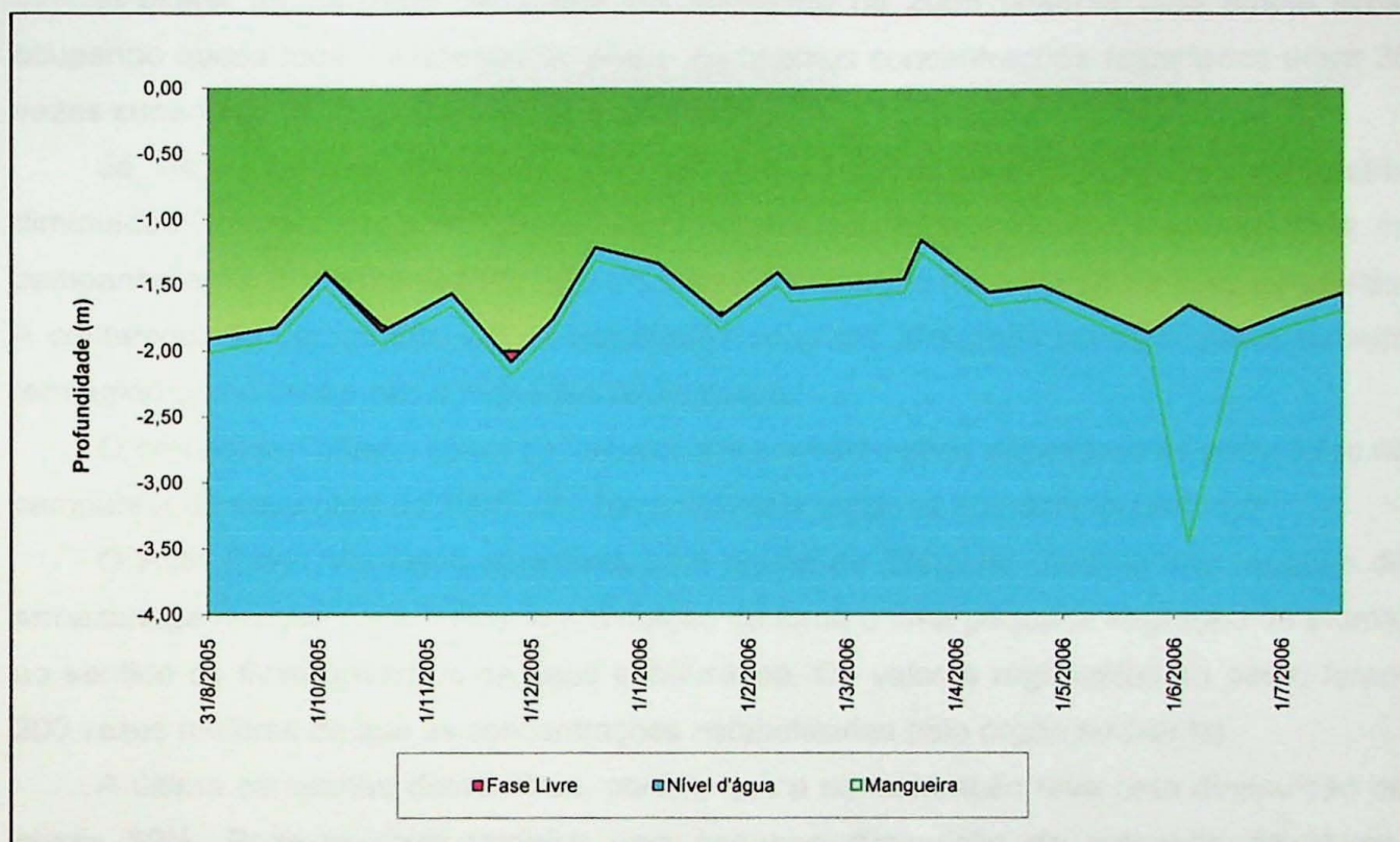
Figura 22- Auto Posto Vermelho - Profundidade da fase livre, nível d'água e mangueira extratora no poço de bombeamento PB01
