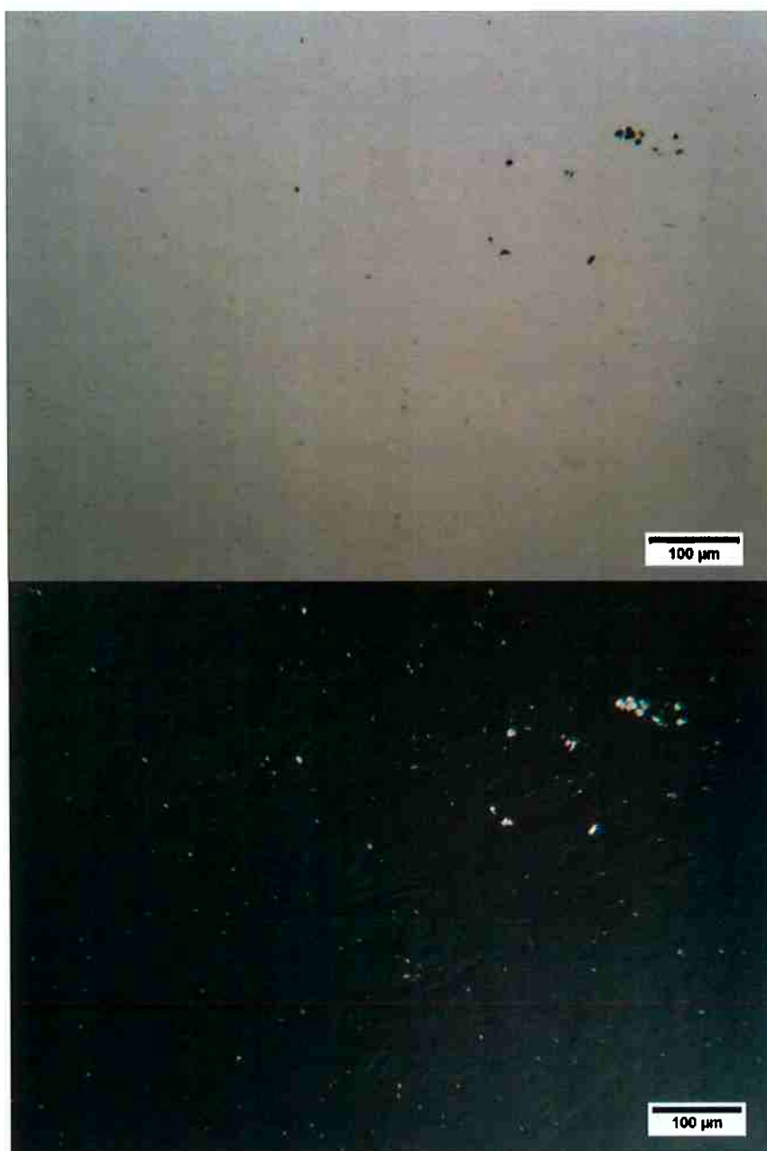
Figura 27 - Imagens de ocular de 200x de aumento para campo claro e escuro, sem ataque. Temperatura de revenimento de 700°C.
