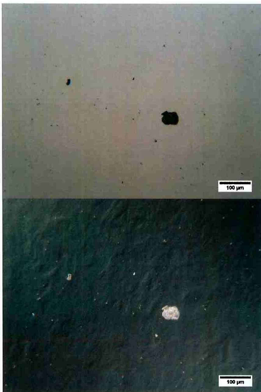
Figura 26 - Imagens de ocular de 200x de aumento para campo claro e escuro, sem ataque. Temperatura de revenimento de 650°C.
