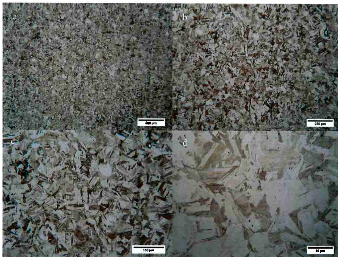
Figura 28 - Revenimento de 550°C. a) Aumento de 50x. b) Aumento de 100x. c) Aumento de 200x. d) Aumento de 500x.
