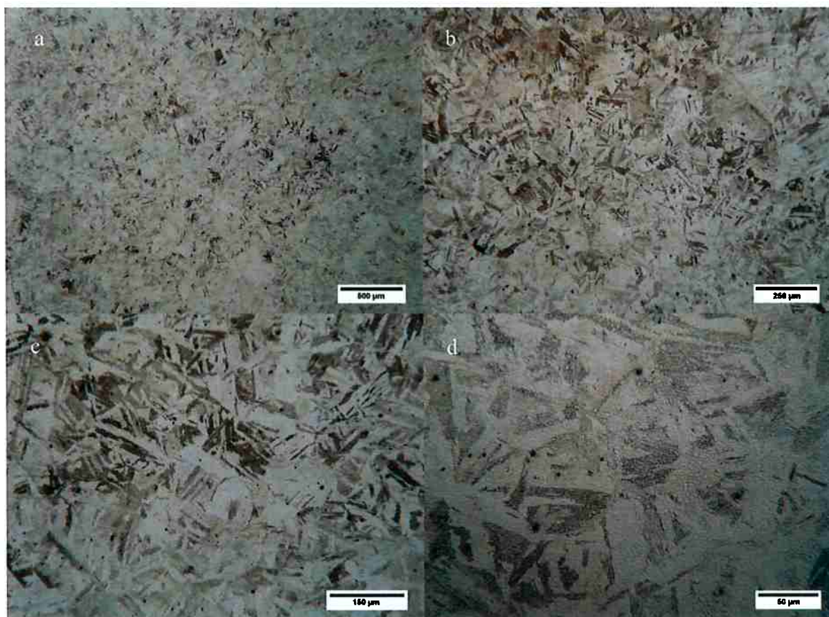
Figura 30 - Revenimento de 700°C. a) Aumento de 50x. b) Aumento de 100x. c) Aumento de 200x. d) Aumento de 500x.
