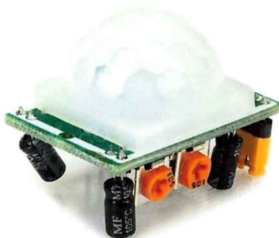
Figura 20 – Sensor de movimento, HC-SR501.
