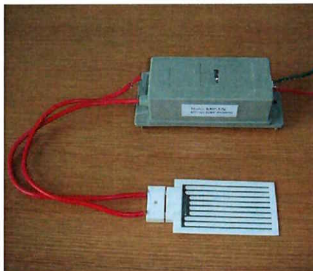
Figura 8 – Exemplo de uma placa cerâmica para produção de gás ozônio (O 3 ).
