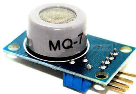
Figura 13 – Sensor de CO, MQ-7.
