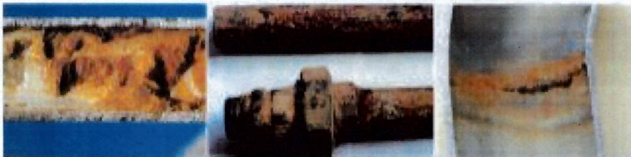
Figura 7 - Exemplos de rompimento de tubulações de metal devido a oxidação
