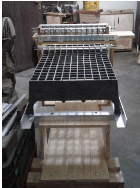
Figura 87 - Altura e posição das guias de alumínio para deposição da bandeja Fonte: Foto tirada pelo autor (2017)
