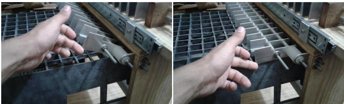
Figura 88 - Mecanismo "prende tubetes" e posição de atuação Fonte: Foto tirada pelo autor (2017)
