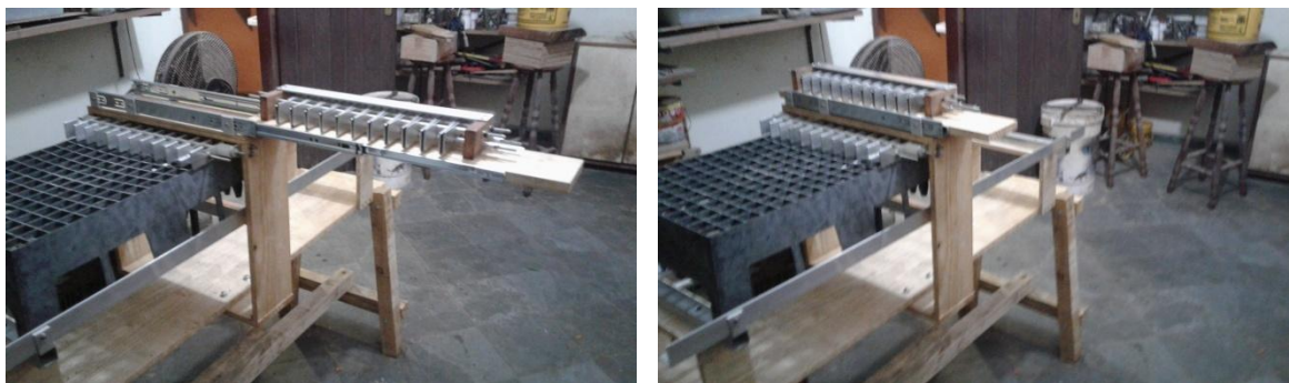
Figura 92 - Mecanismo de "gaveta" e posições de atuação Fonte: Foto tirada pelo autor (2017)
