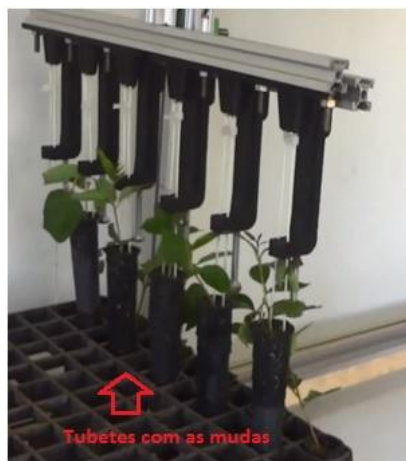
Figura 12 - Mecanismo em T para retirada de tubetes Fonte: Lopes e Velloso (2015)
