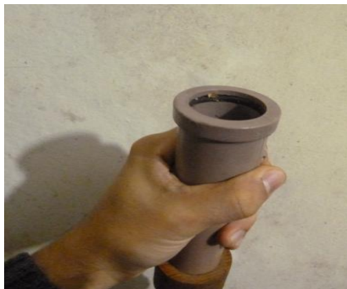
Figura 25 – Bocal para disparo de ar em tubete Fonte: Foto tirada pelo autor (2016)
