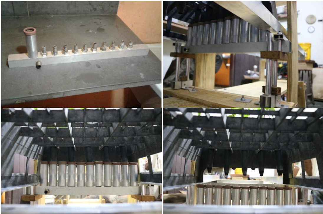
Figura 91 - Base dos "bocais de desentubetamento" Fonte: Foto tirada pelo autor (2017)
