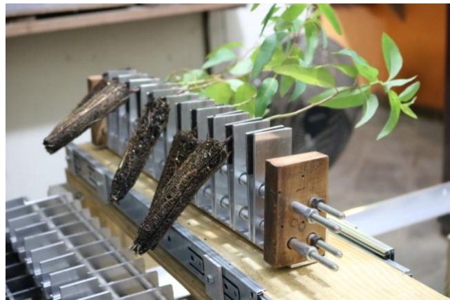
Figura 53 - Protótipo do sistema de garras em posição de “elevação” de mudas.
