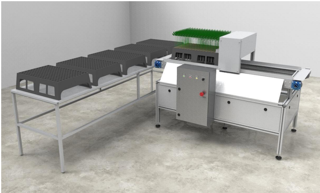
Figura 59 - Layout de solução, vista superior do equipamento em 3D. Fonte: Elaborado pelo autor (2017)
