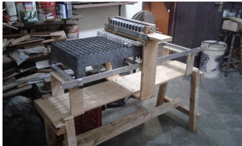
Figura 86 - Bancada em madeira com guias de apoio em alumínio Fonte: Foto tirada pelo autor (2017)
