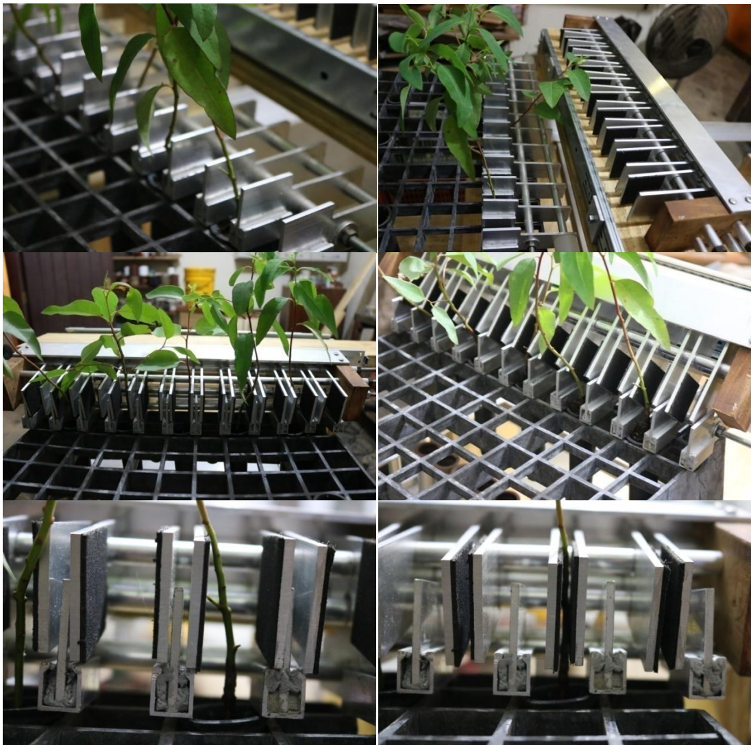
Figura 90 - Conjunto de garras e "prende tubetes" em suas posições de atuação Fonte: Foto tirada pelo autor (2017)
