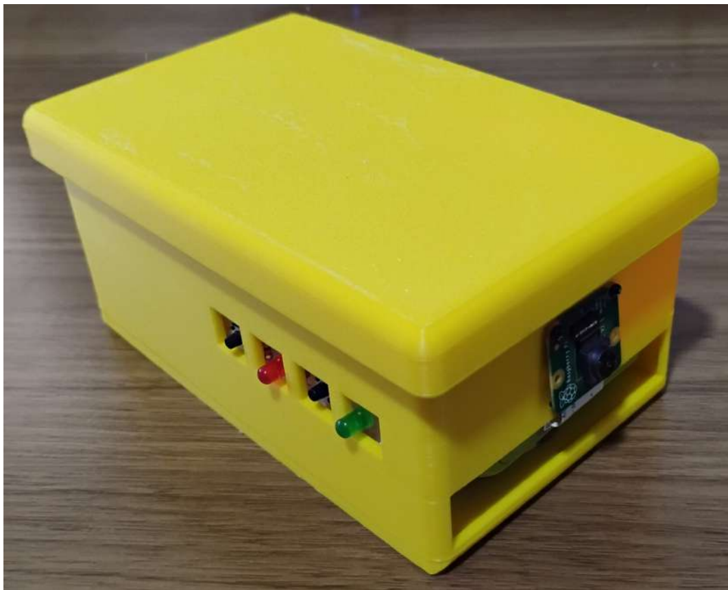
Figura 27 – Protótipo utilizando câmera modular
