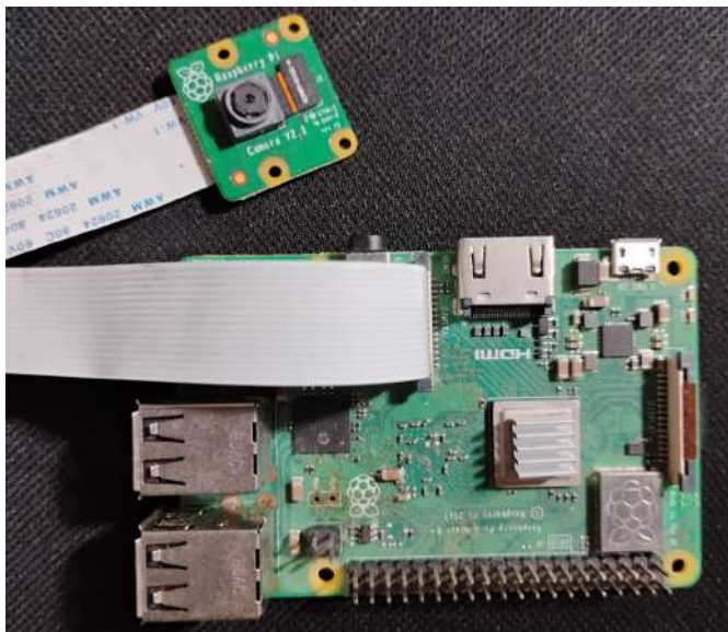
Figura 24 – Raspberry Pi 3 Modelo B+ com câmera modular v2.1
