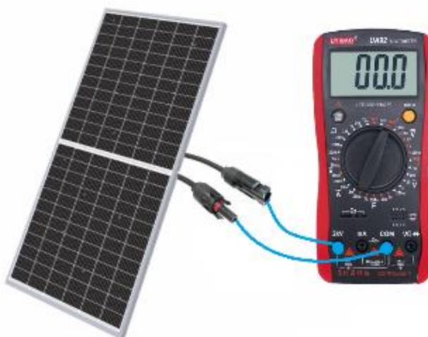
Figura 14 — Verificação de tensão de circuito aberto
