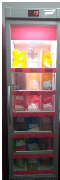
Figura 45 - Freezer vertical utilizado nos ensaios da Proposta 2 com 15 nichos disponíveis
