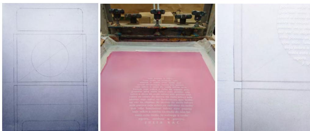
Figuras 154, 155 e 156: Faca da mala com dimensões finais, tela de serigrafia gravada e detalhe do vinco manual
