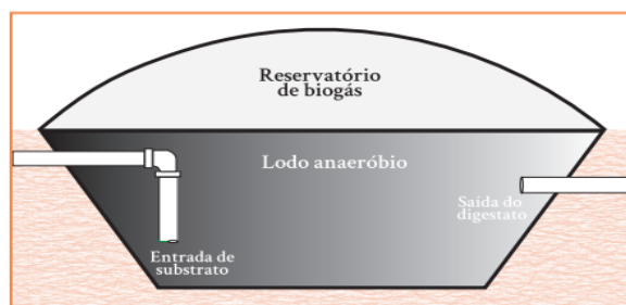
Figura 6. Esquema representativo da visão interna do reator modelo lagoa coberta (Kunz, 2019).
