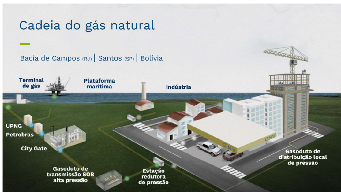
Figura 9 - Esquema de todas as etapas da cadeia de gás natural.
