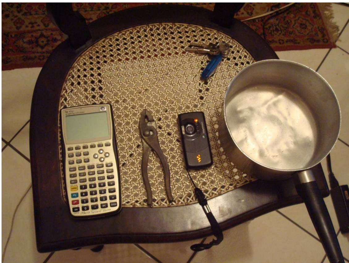
Figura 30 - Objetos utilizados para medir o efeito de materiais ferromagnéticos na bússola
