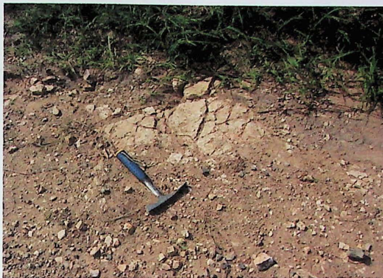
Figura 9: Padrão de fraturamento observado em silexito. São juntas híbridas que indicam direção de SHmáx na bissetriz do ângulo agudo formado pelas famílias.
