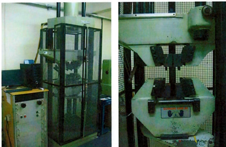
Figura 4-3 – Imagens da máquina utilizada para os ensaios de tração
