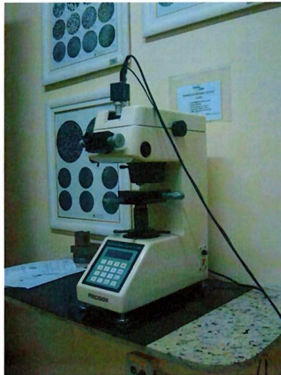
Figura 4-5 – Microdurometro utilizado nos ensaios
