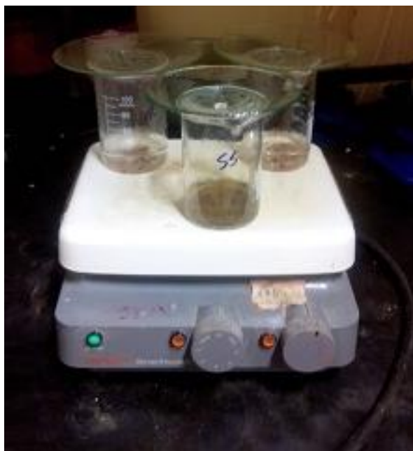
Figura 4 - Sistema de aquecimento das amostras (Etapa 3 da extração sequencial).
