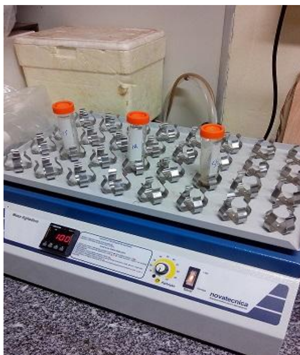
Figura 3 - Sistema de agitação das amostras - Etapa 1 da extração sequencial.
