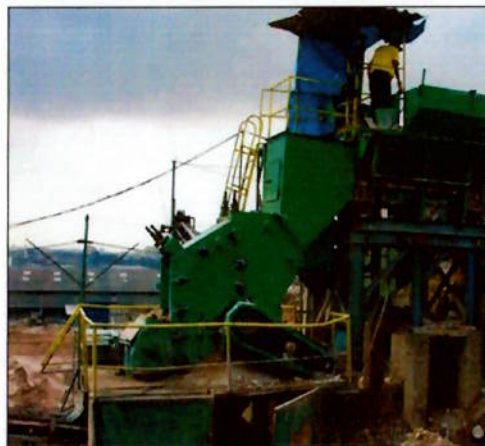
(b) detalhe do britador de impacto
