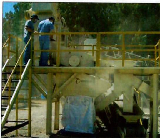
b) Detalhe do circuito fechado com peneira
