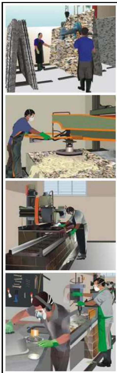
Figura 8 – Etapas do beneficiamento do mármore. Fonte: Santos et al , 2008.
