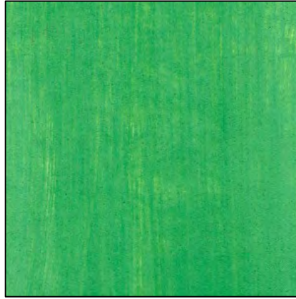
Figura 65 – Amostra pintada de green earth
