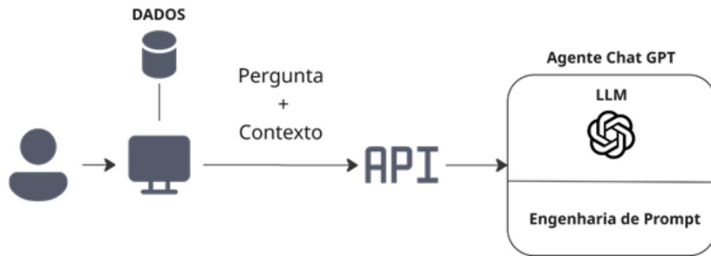
Figura 6 – Arquitetura da abordagem Retrieval-Augmented Generation (RAG). Neste fluxo, a pergunta é convertida em embedding , comparada com um índice FAISS e os trechos mais relevantes do FAQ são recuperados para compor o prompt enviado ao LLM.
