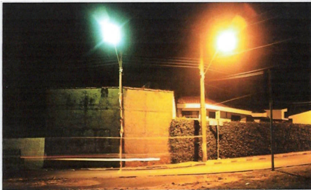
Figura 9 – Comparação entre o sistema de IP de lâmpada de sódio e de lâmpada de mercúrio
