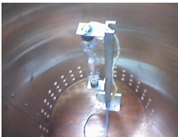
Figura 2.14: Lâmpada de descarga em câmara cilíndrica para tomada espectral.
