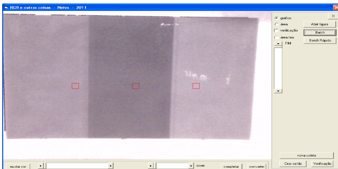
Figura 2.9: Programa ARI-LUHIEN II durante análise de fotografia em radiação IV dos pigmentos metaméricos A, B e C.
