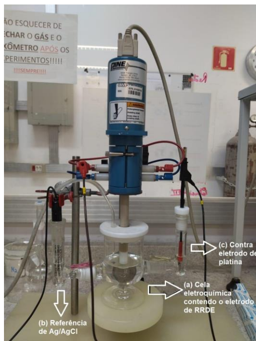
Figura 7. Cella eletroquímica contendo o eletrodo de RRDE (a), referência de Ag/AgCl (b) e contra eletrodo de platina (c).
